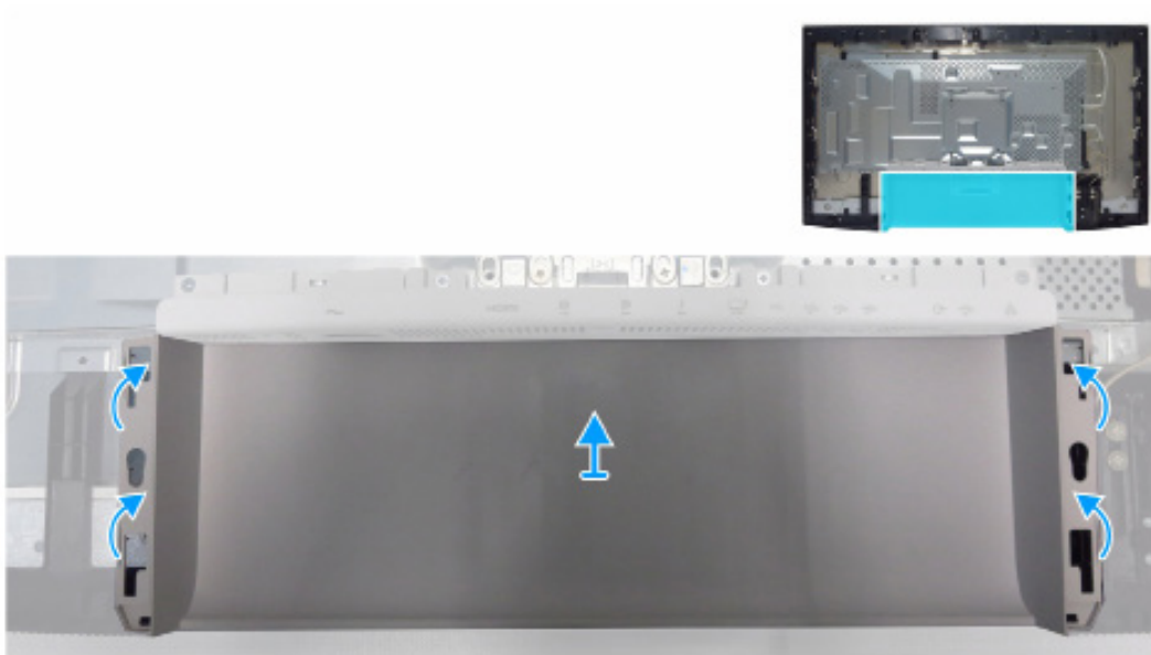
Figura 4. Retire la cubierta inferior trasera
