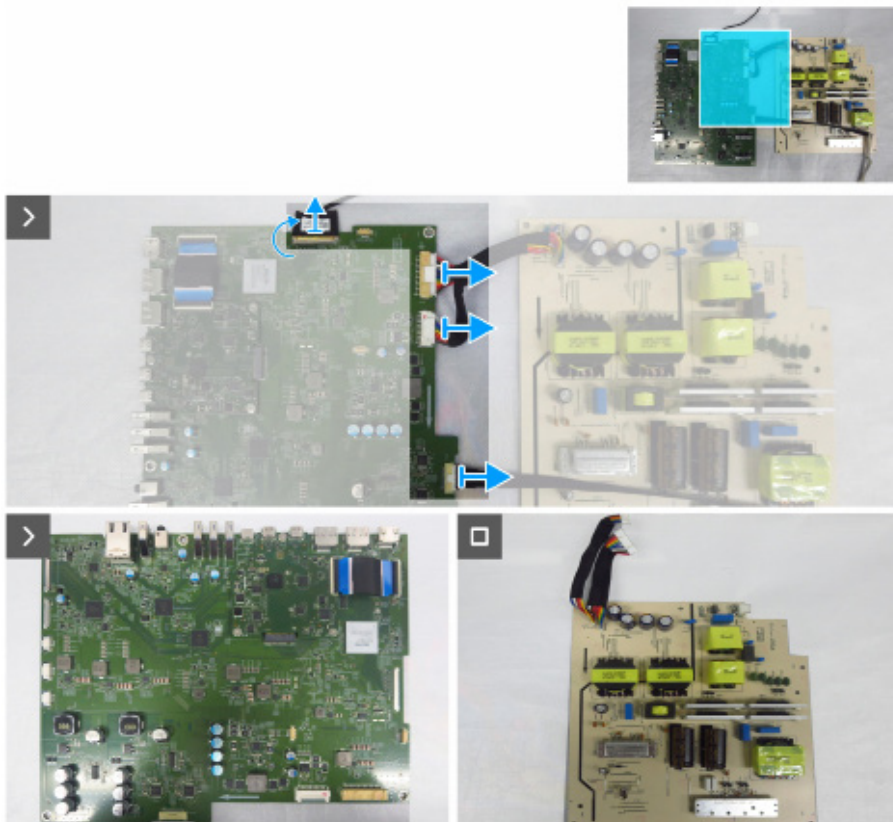
Figura 15. desconecte los cables de la placa principal
