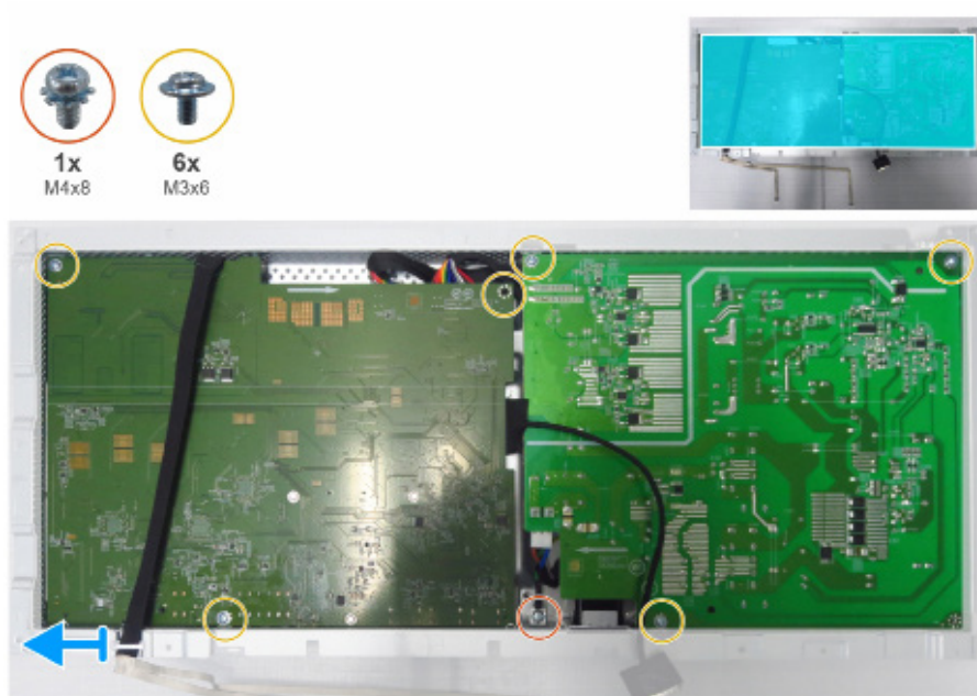
Figura 13. Retire la placa principal y la placa de alimentación.
