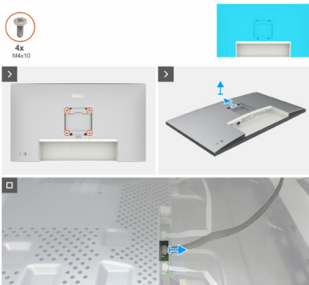
Figura 2. Retire la cubierta superior trasera
