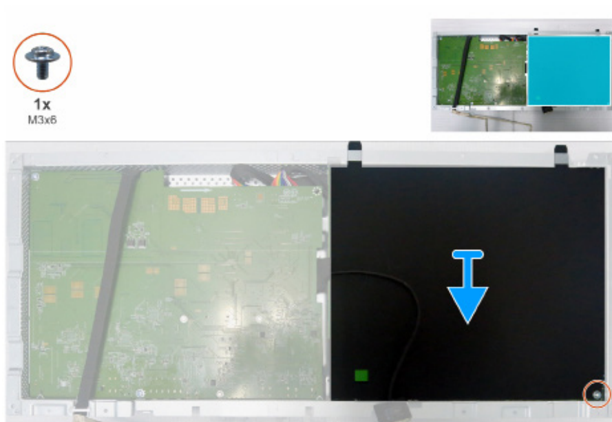
Figura 12. Retire la lámina de Mylar
