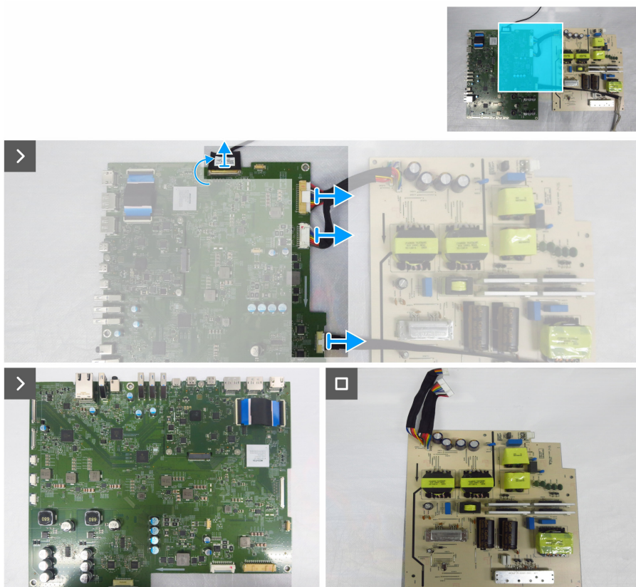
Figura 43. Desconecte los cables de la placa principal
