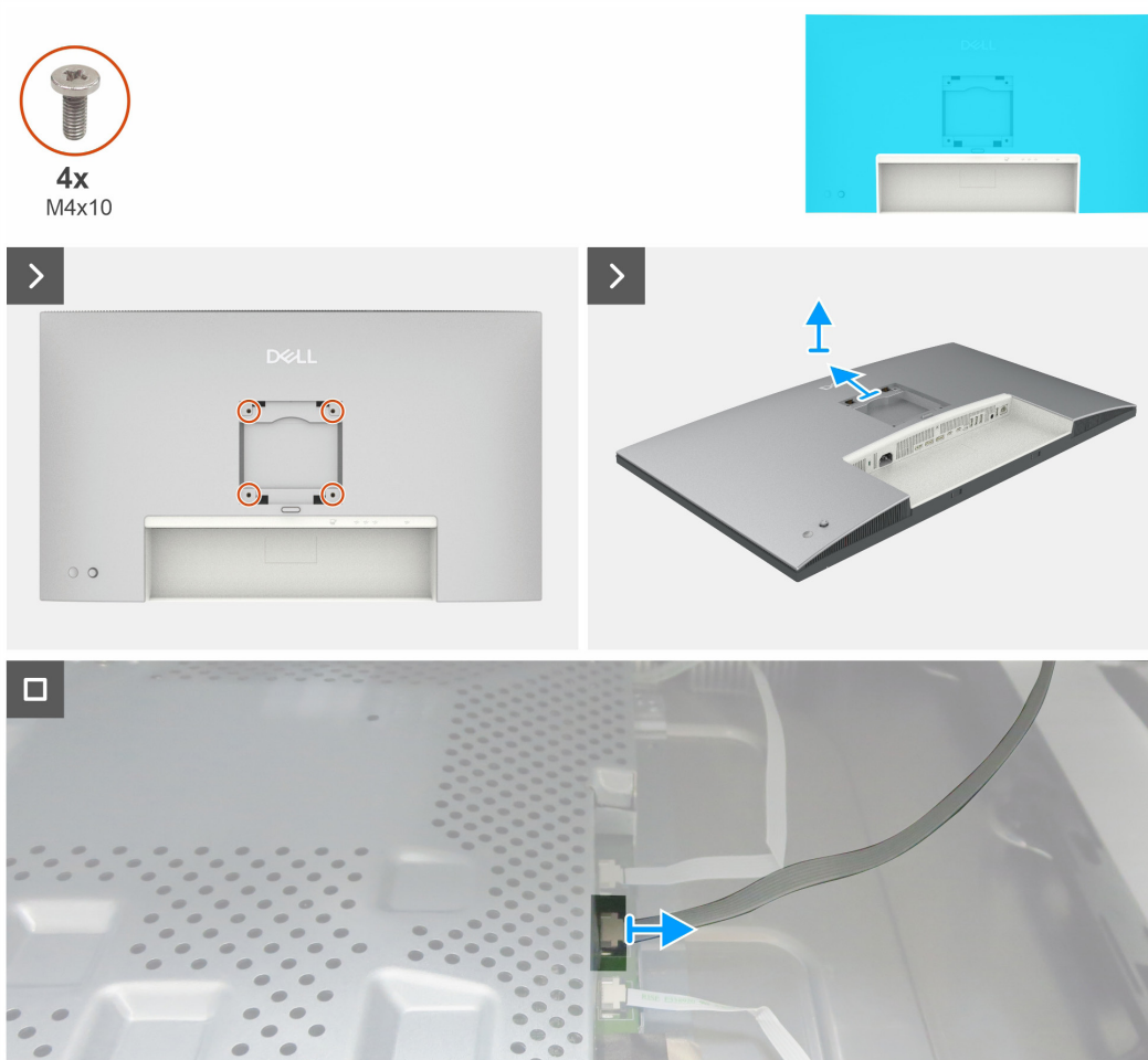
Figura 21. Retire la cubierta superior trasera
