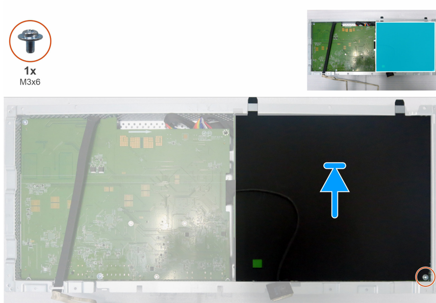
Figura 47. Instale la lámina de Mylar
