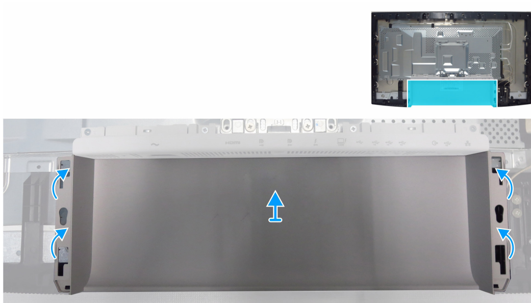
Figura 25. Retire la cubierta inferior trasera
