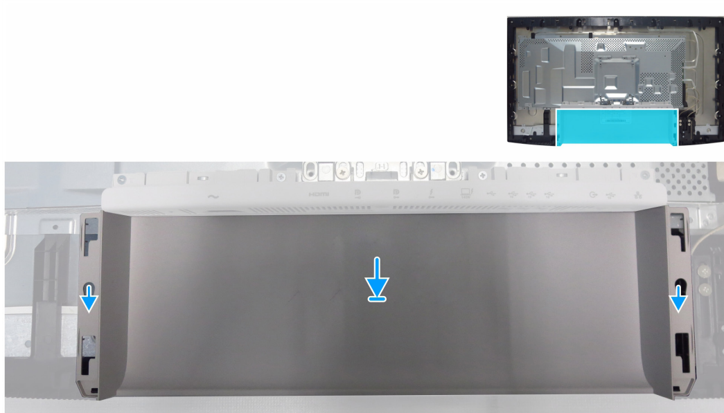
Figura 26. Instale la cubierta inferior trasera
