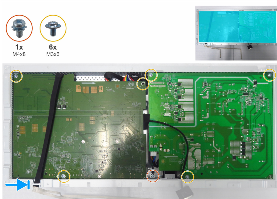
Figura 46. Instale la placa principal y la placa de alimentación
