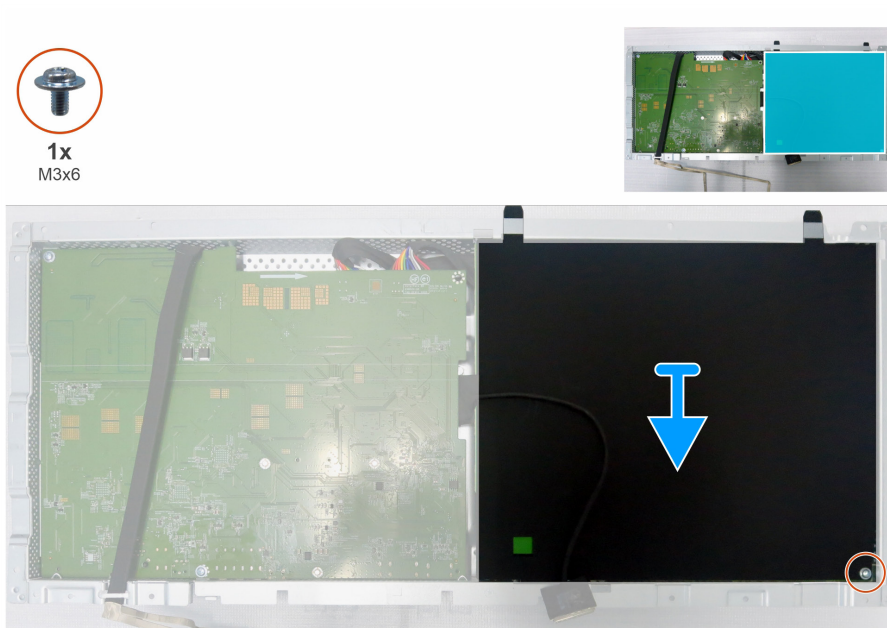
Figura 40. Retire la lámina de Mylar
