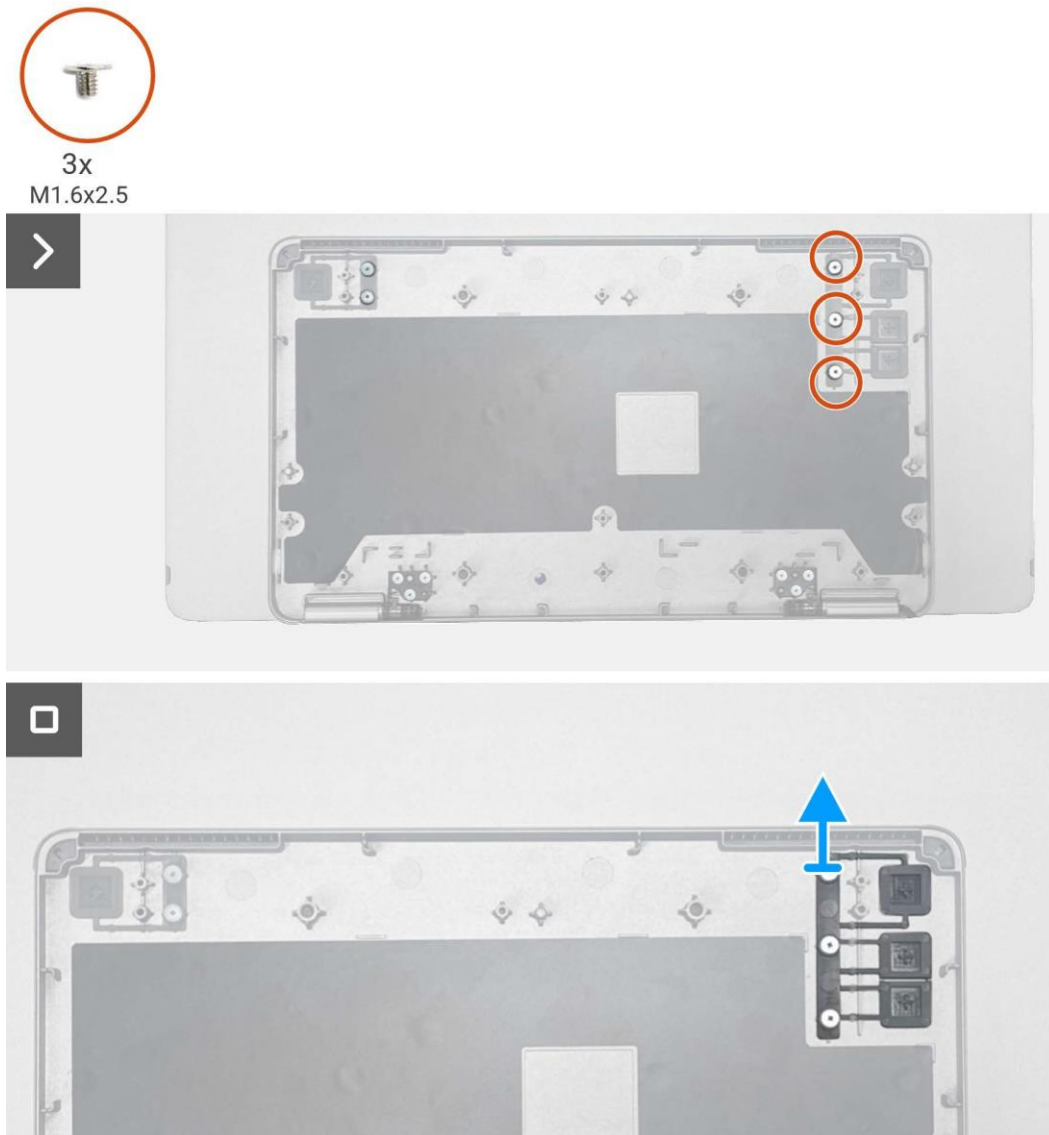
Imagen 21. Extracción del botón de función
