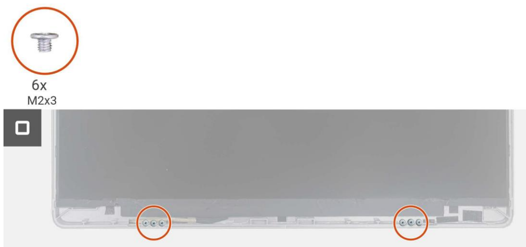
Imagen 18. Instalación de la bisagra
