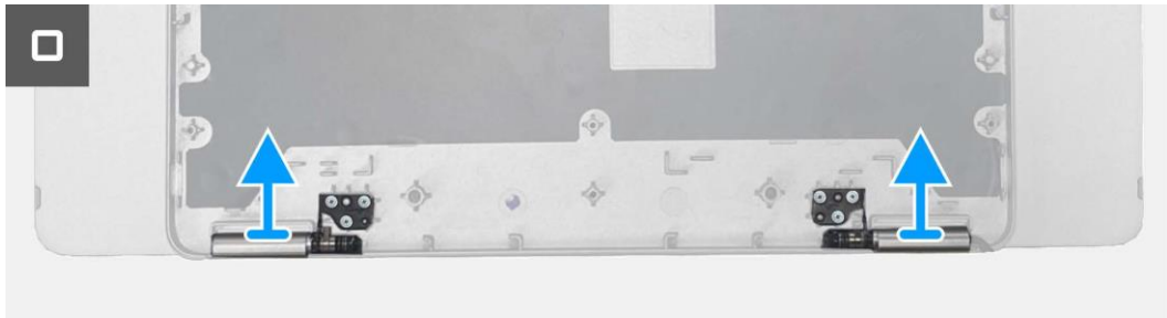
Imagen 16. Extracción del soporte
