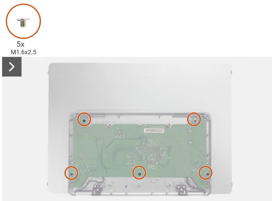
Imagen 6. Extracción de la placa principal
