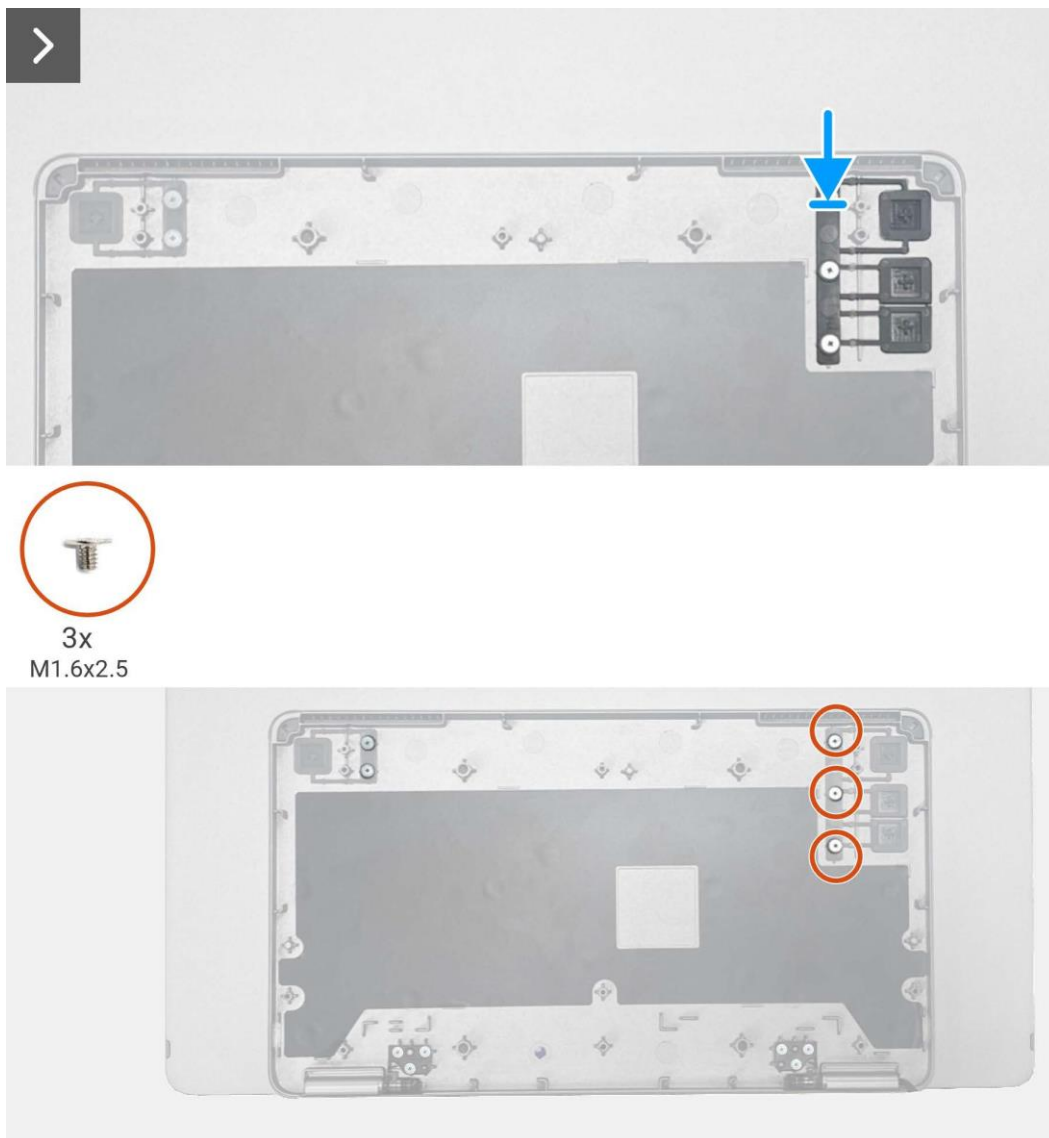
Imagen 22. Instalación del botón de función
