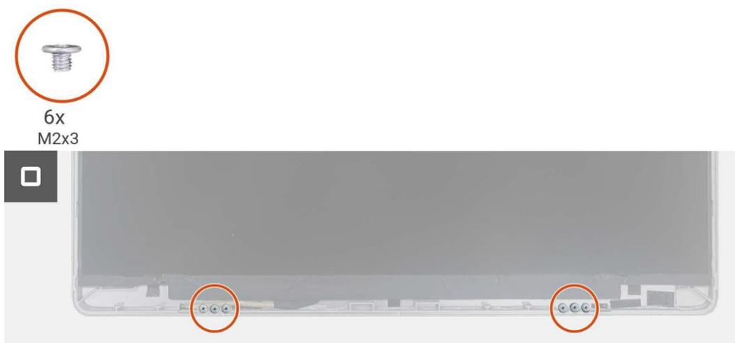
**Figura 18. Installazione della cerniera**
