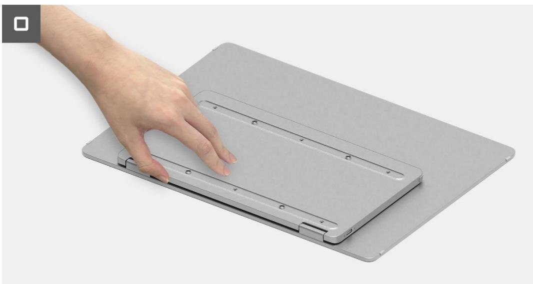
**Figura 4.** Rimozione della copertura della base inferiore
