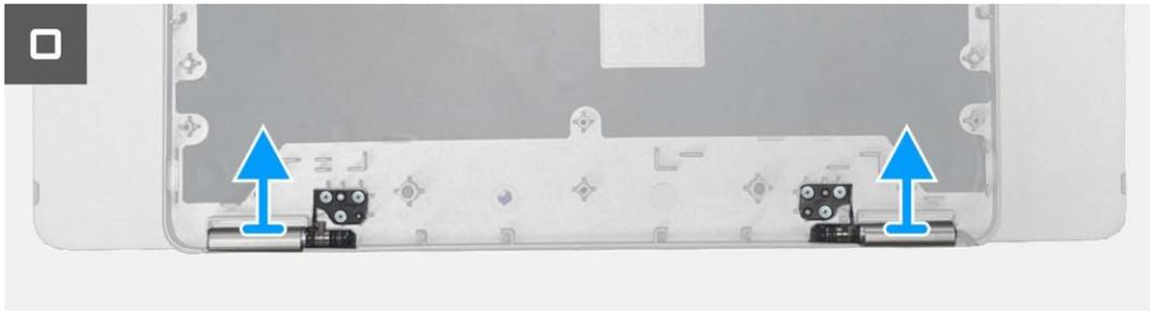
**Figura 16. Rimozione della cerniera**
