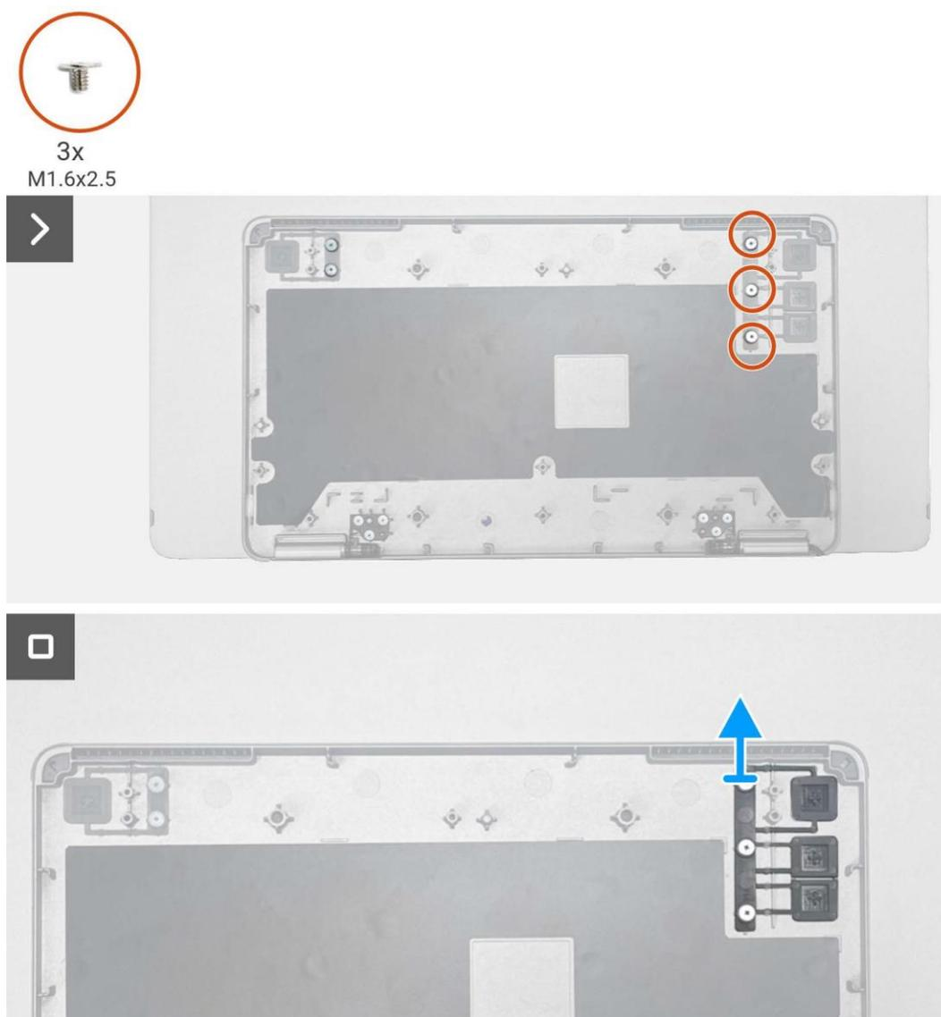
**Figura 21. Rimozione del pulsante funzione**
