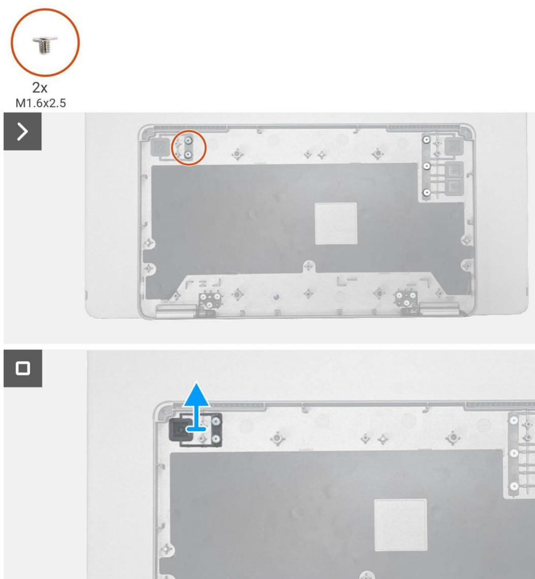
**Figura 19. Rimozione del pulsante di accensione**
