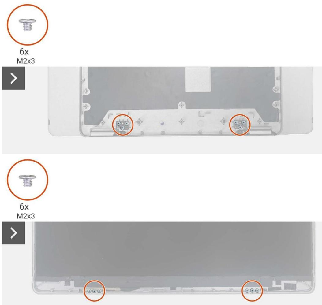
**Figura 24. Rimozione della cerniera**
