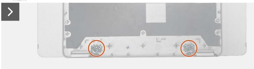
**Figura 26. Installazione della cerniera**
