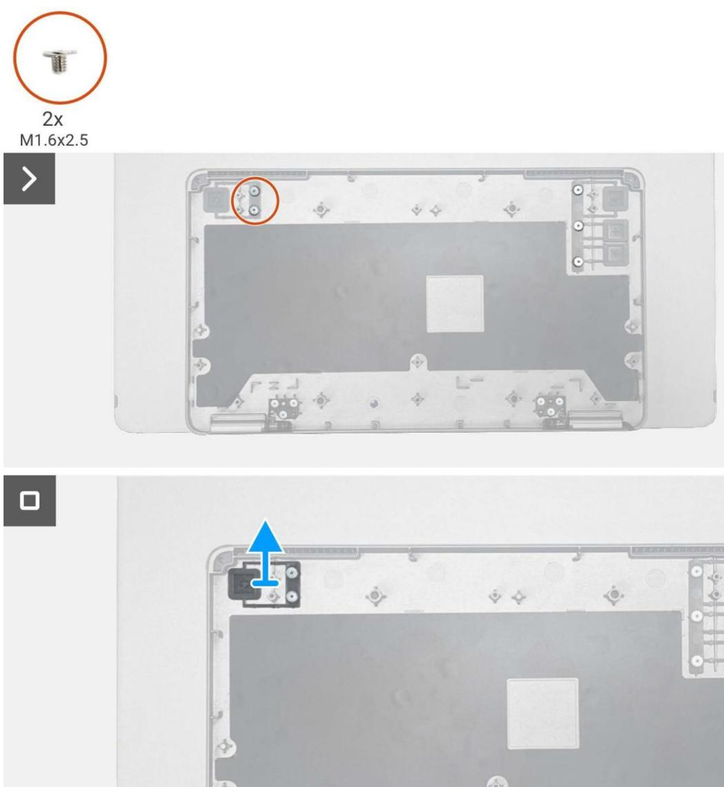
**Figura 28.** Rimozione del pulsante di accensione
