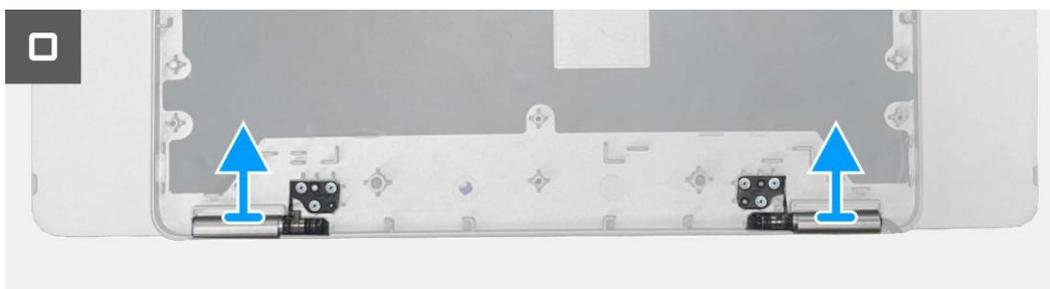
**Figura 25. Rimozione della cerniera**
