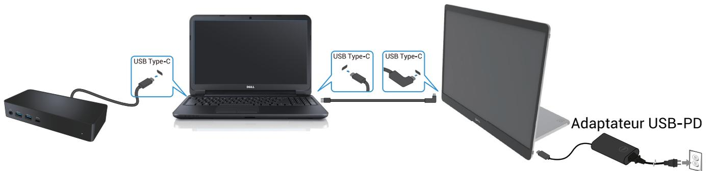
Figure 15. Utilisation avec un dispositif d'accueil (Écran connecté à l'adaptateur)
