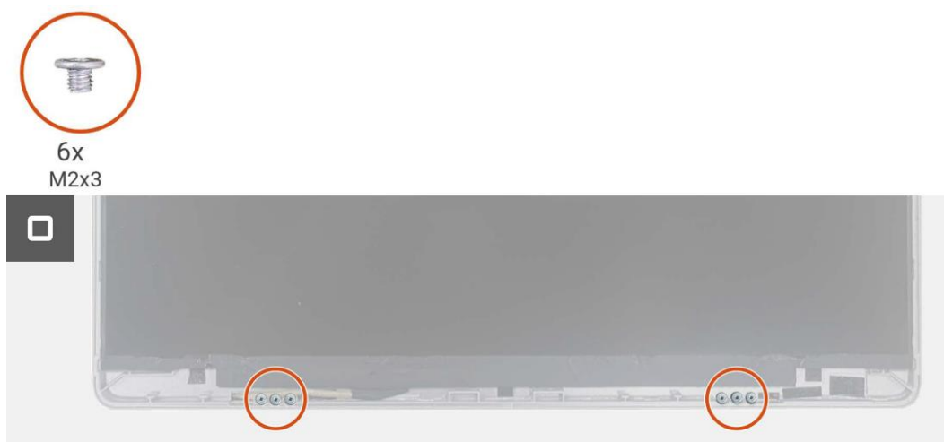
Figure 27. Installation de la charnière
