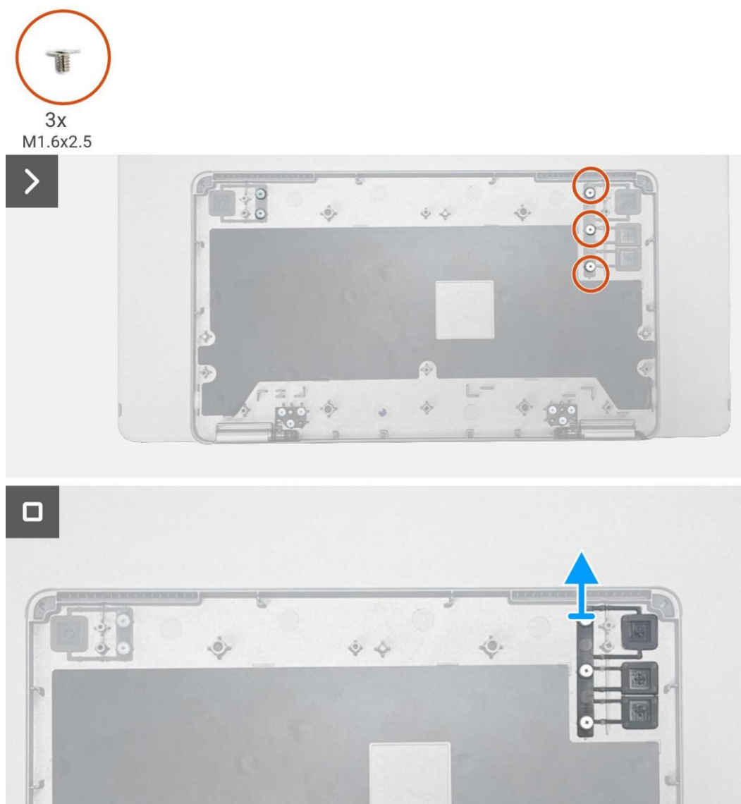
Obrázek 21. Odmontování tlačítka funkcí
