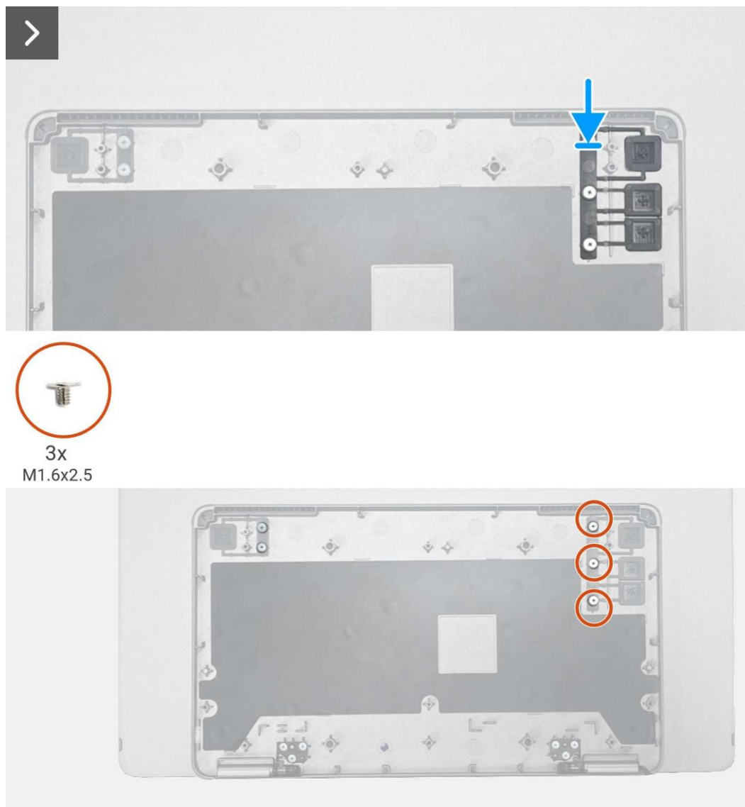
Obrázek 22. Instalace tlačítka funkcí
