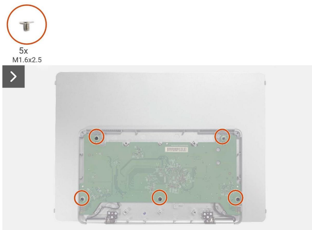
Obrázek 6. Odmontování hlavní desky
