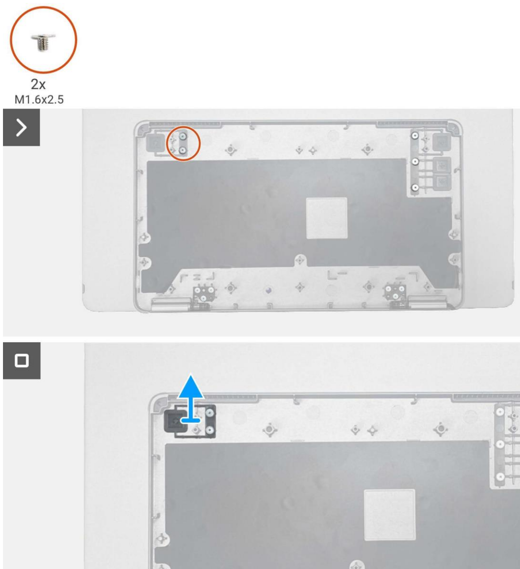
Obrázek 19. Odmontování tlačítka napájení
