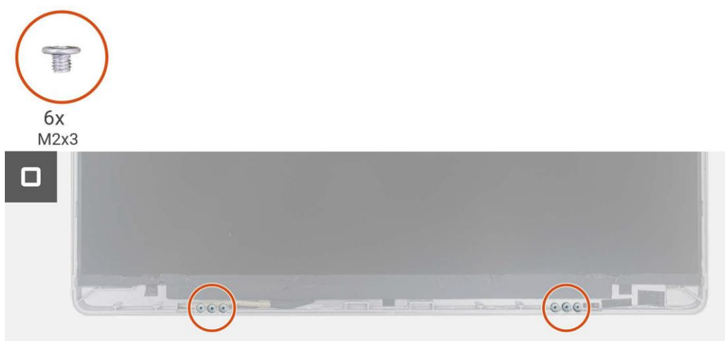
Figure 18. Installation de la charnière
