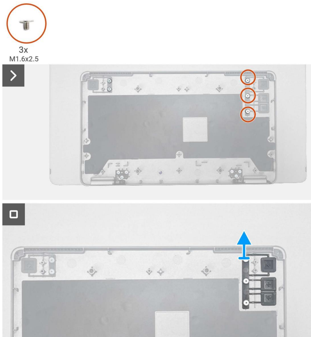
Figure 21. Retrait du bouton de fonction
