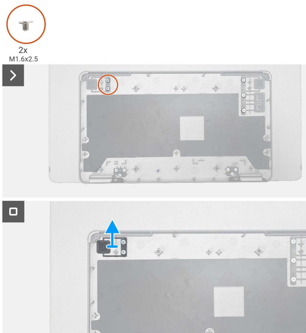
Figure 19. Retrait du bouton d'alimentation
