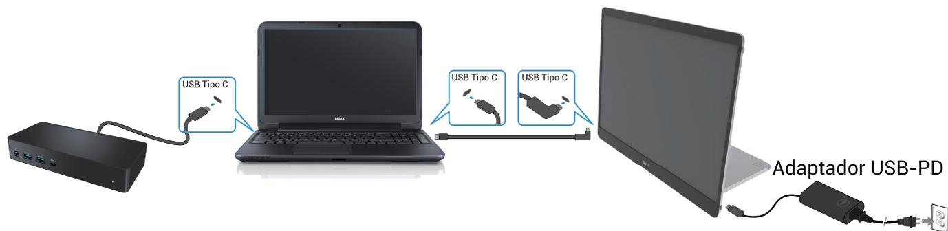
**Figura 15.** Utilização da ficha com dispositivo de ancoragem (monitor conectado ao adaptador)
