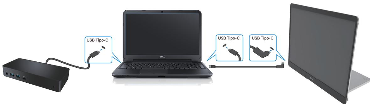
Figura 14. Utilizzo normale con un dispositivo di docking
