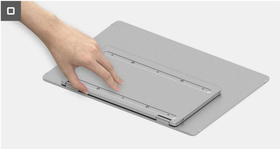
**Figura 4.** Remover a tampa da base inferior
