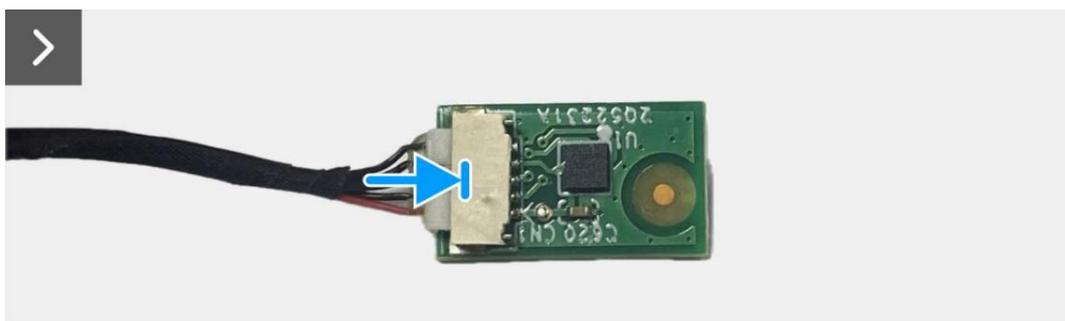
**Figura 13. Instalar a placa do sensor de auto-rotação**
