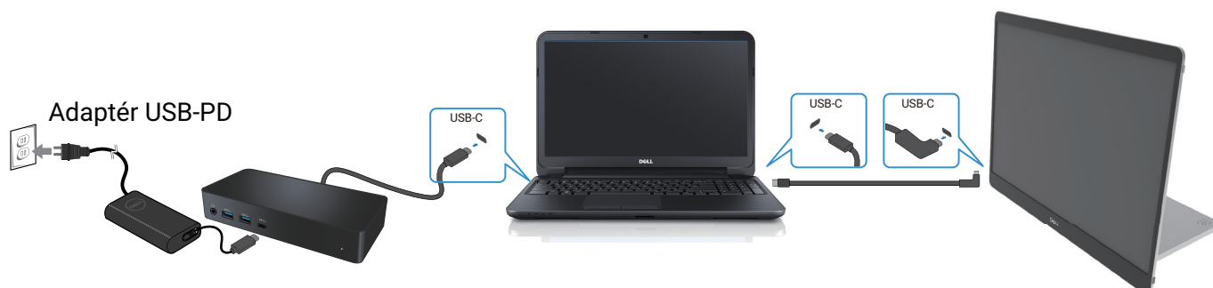
Obrázek 16. Použití zapojení do el. sítě s dokovacím zařízením
