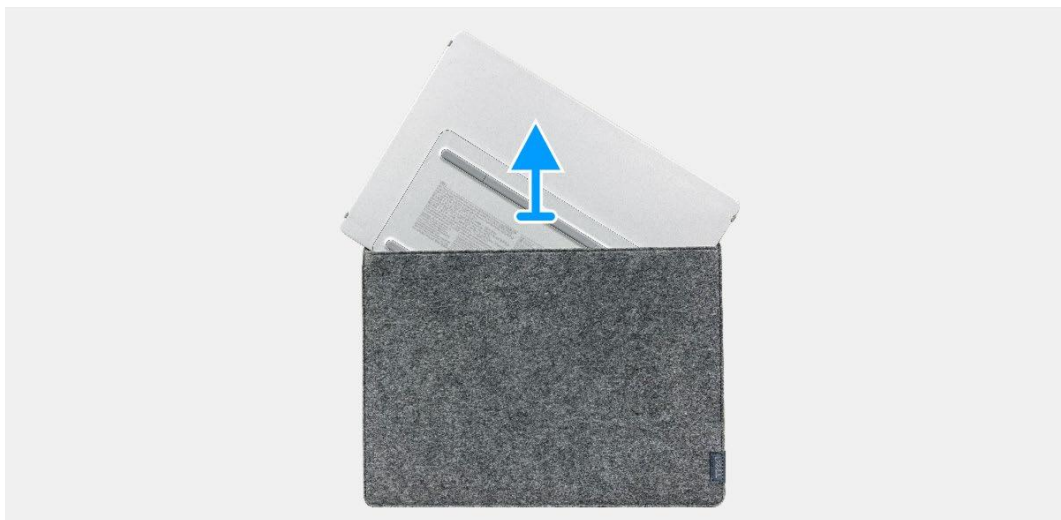
Rysunek 1. Demontaż rękawa
