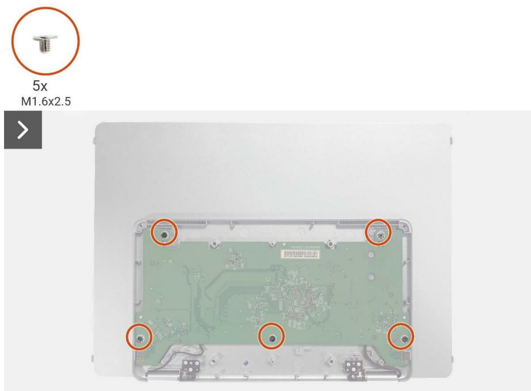
Rysunek 6. Wyjmowanie płyty głównej
