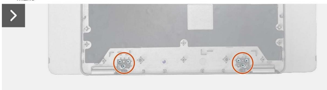
Rysunek 17. Mocowanie zawiasu
