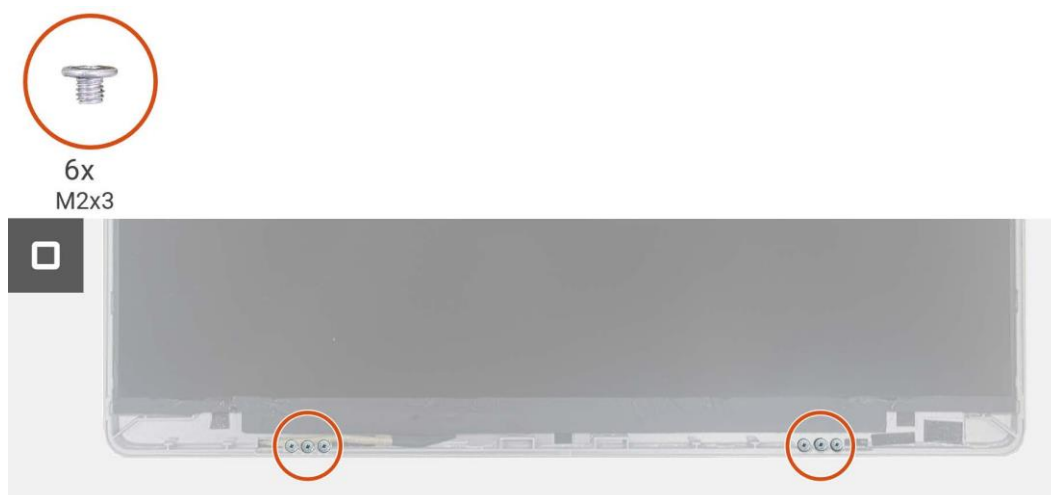
Rysunek 18. Mocowanie zawiasu
