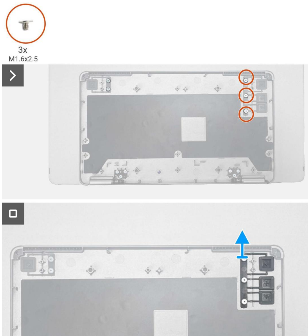
Imagen 30. Extracción del botón de función
