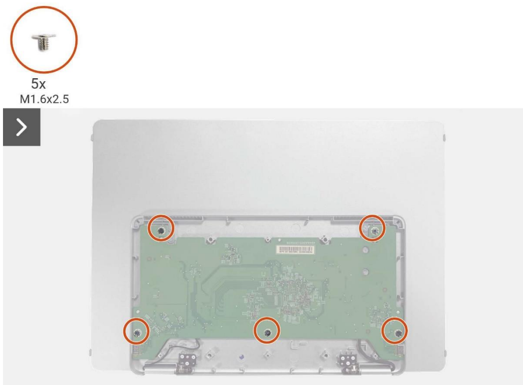
Imagen 15. Extracción de la placa principal
