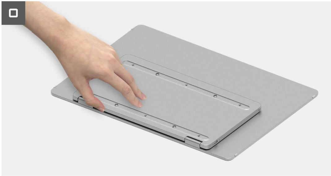
Imagen 13. Extracción de la cubierta trasera
