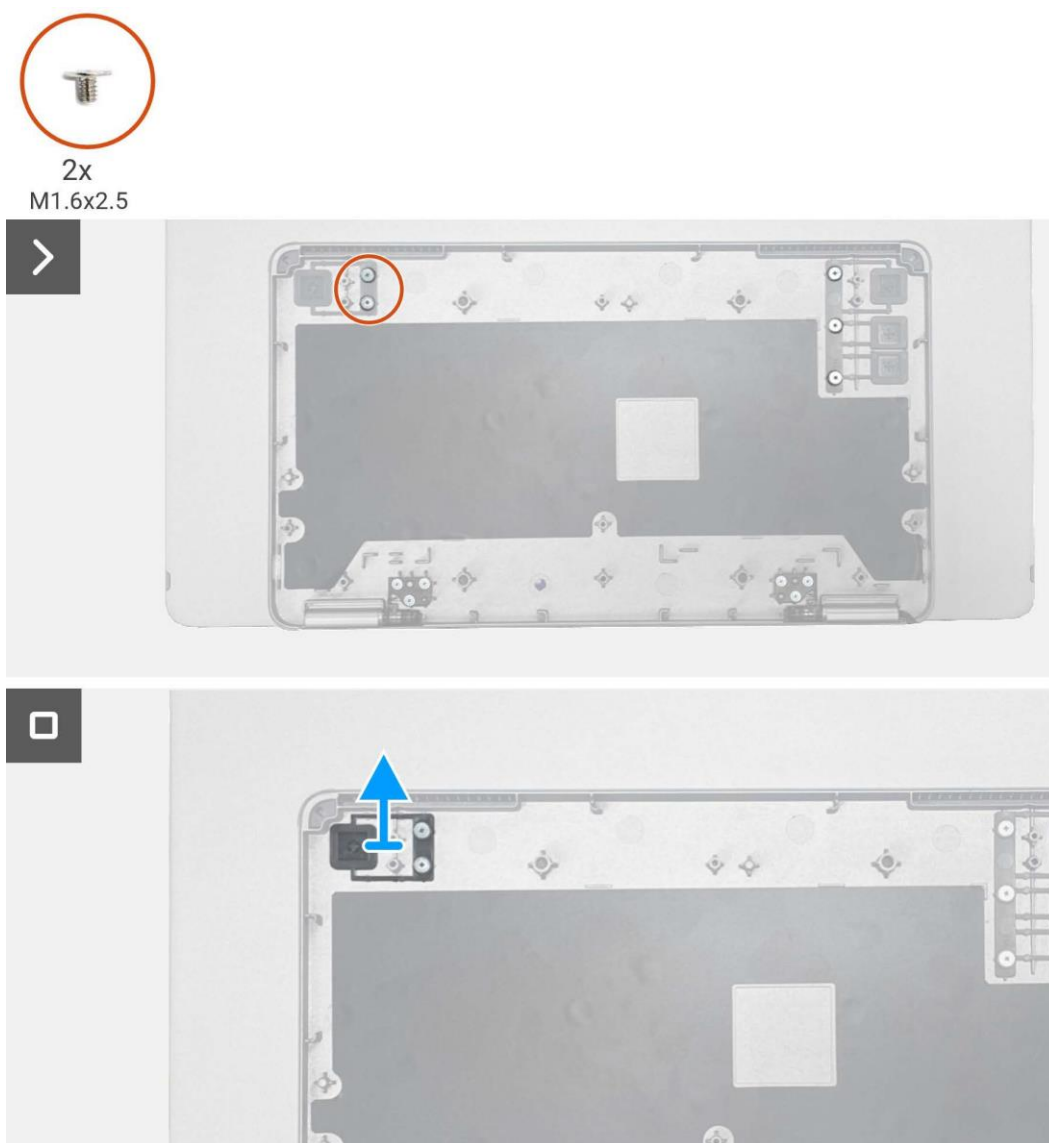
Imagen 28. Extracción de la placa de alimentación
