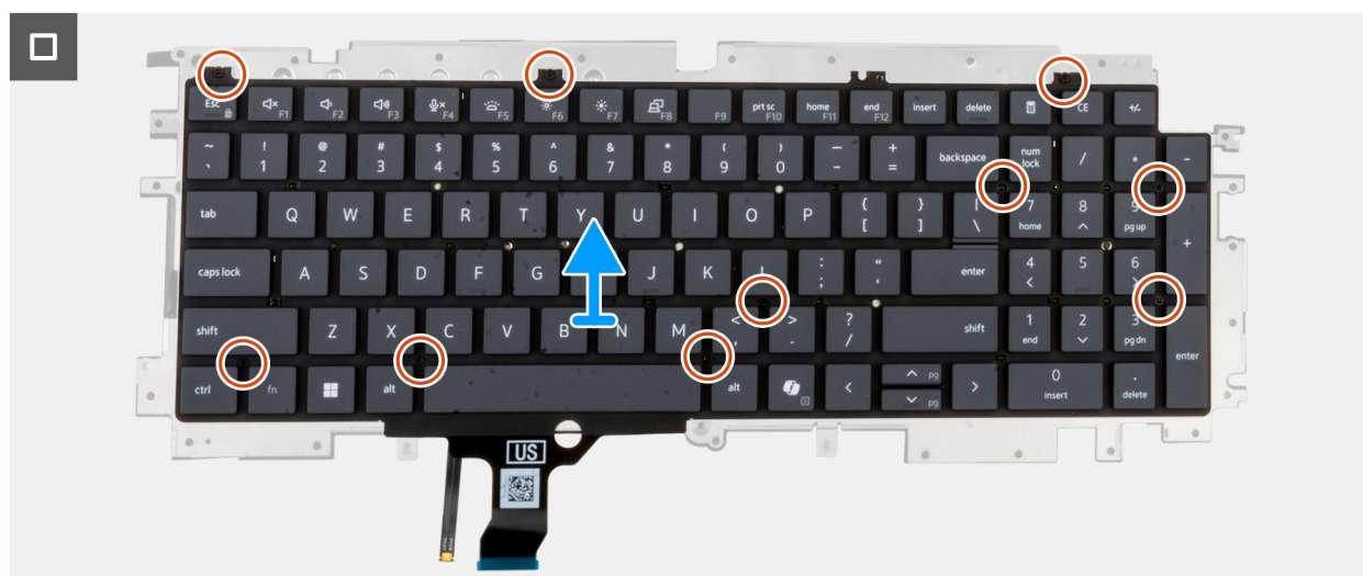
Figura 59. Rimozione della tastiera
