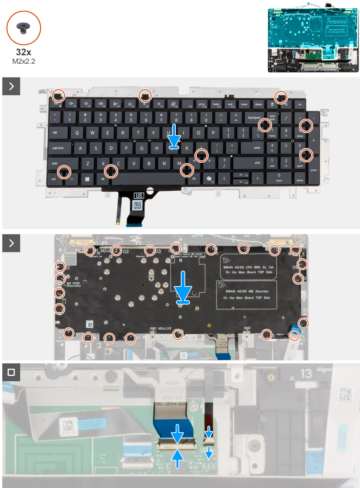
Figura 60. Installazione della tastiera
