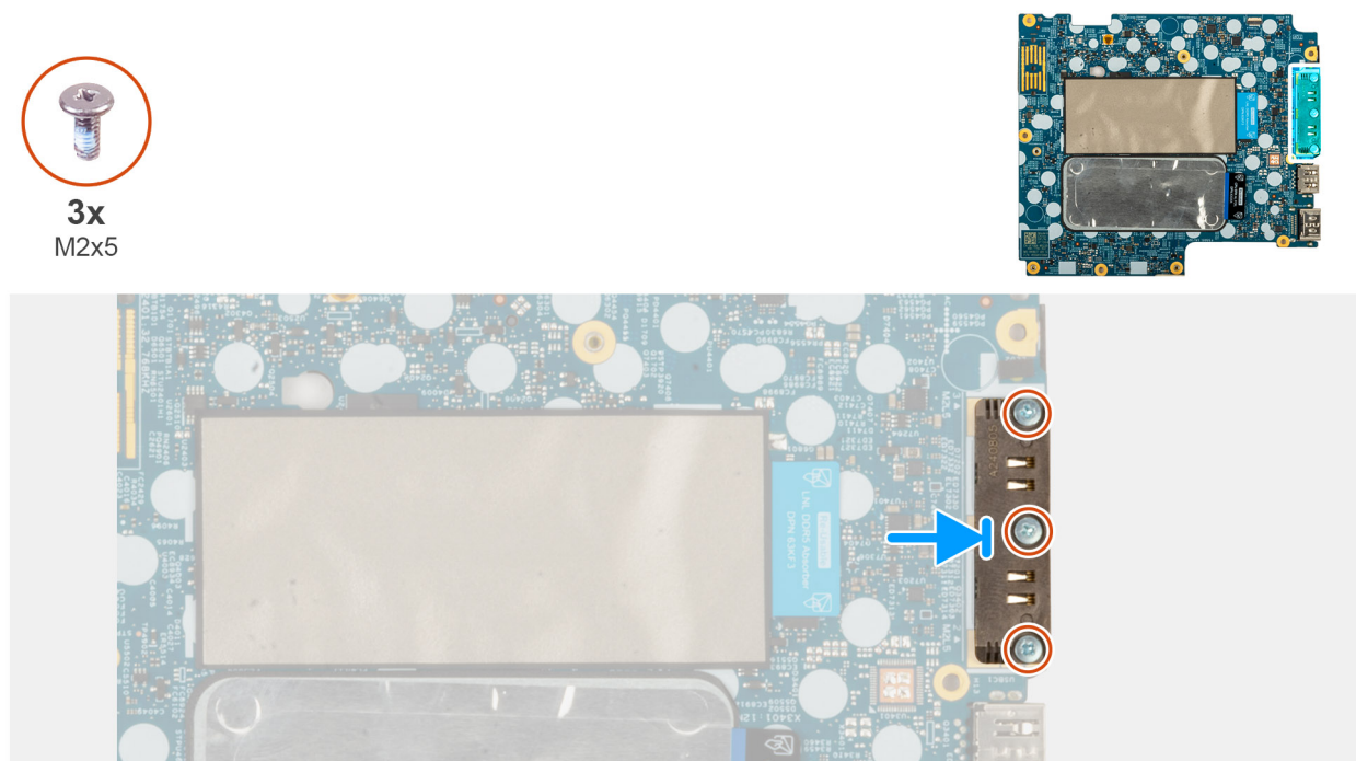
Figura 53. Installazione del modulo del connettore USB Type-C.
