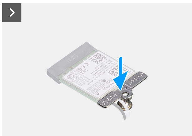
Rysunek 24. Instalowanie karty sieci bezprzewodowej
