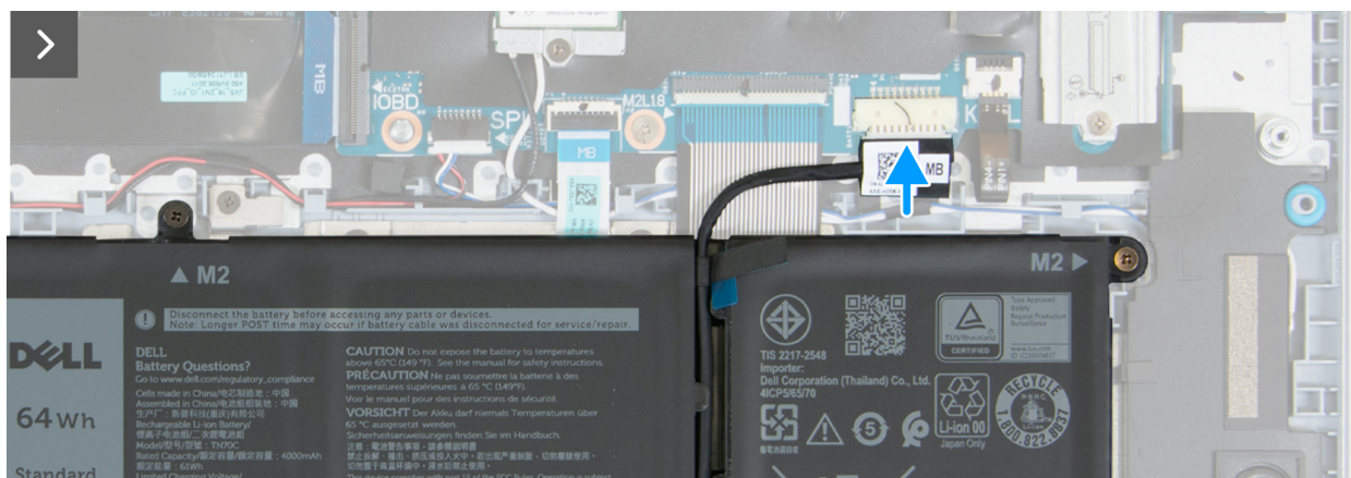
Rysunek 12. Podłączanie kabla baterii
