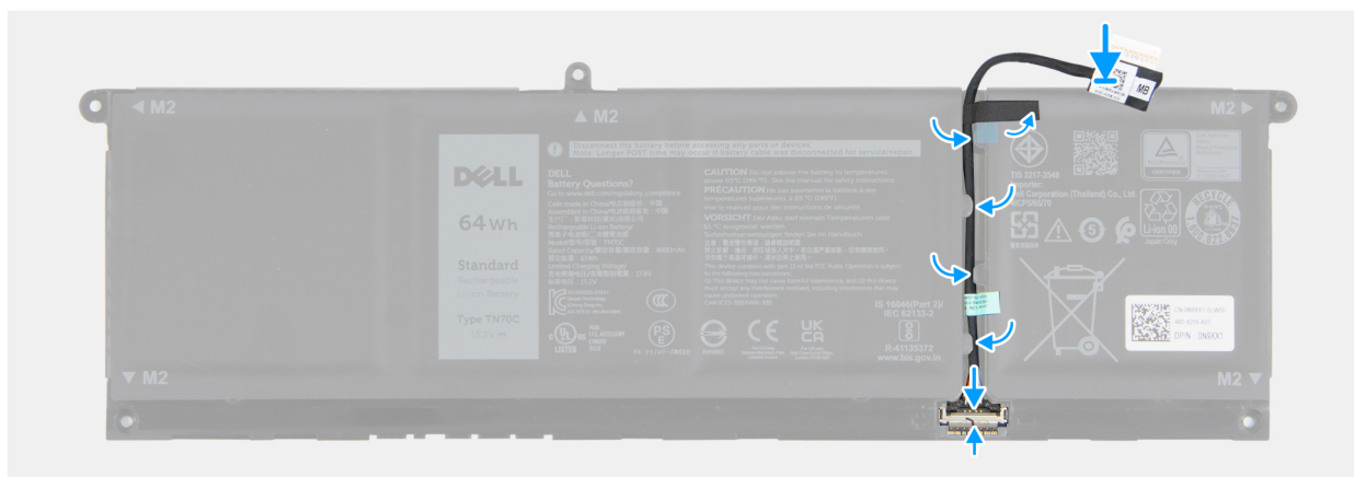
Rysunek 18. Instalowanie kabla baterii
