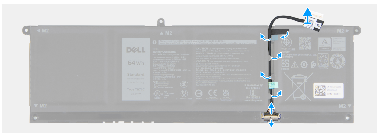
Rysunek 17. Wymontowywanie kabla baterii
