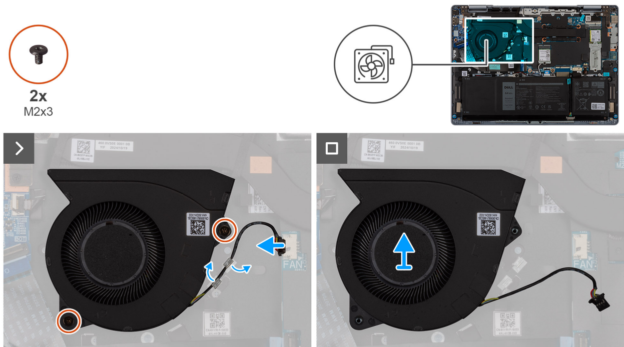
Rysunek 26. Wymontowywanie wentylatora systemowego
