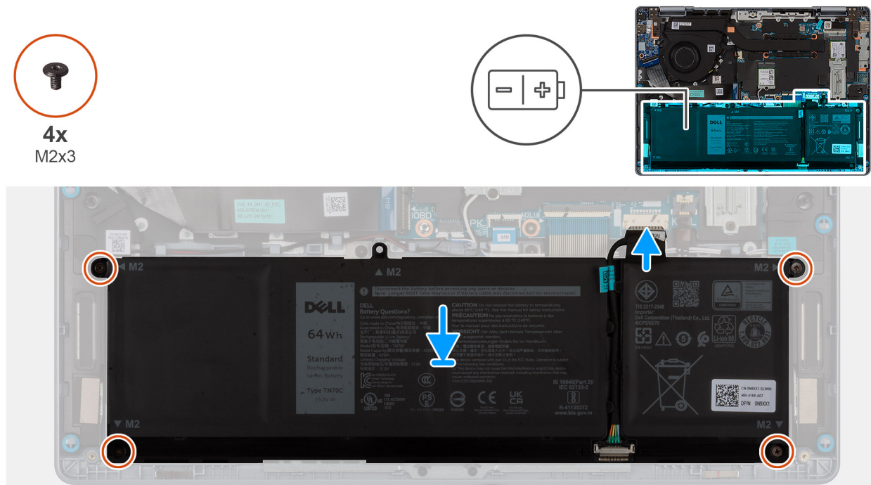
איור 19. התקנת הסוללה
