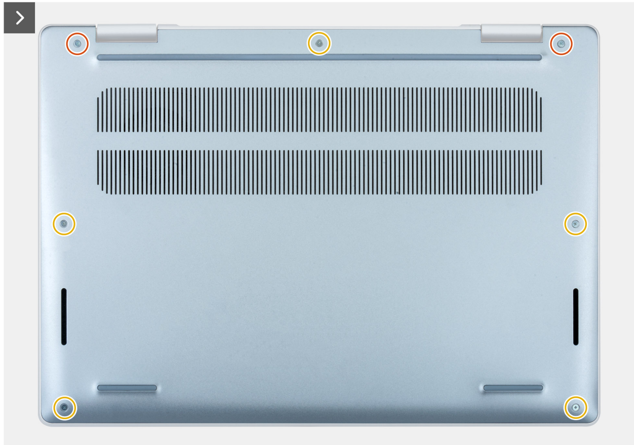
איור 9. הסרת כיסוי הבסיס
