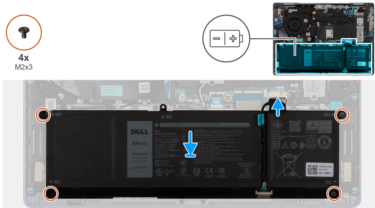
איור 16. התקנת הסוללה
