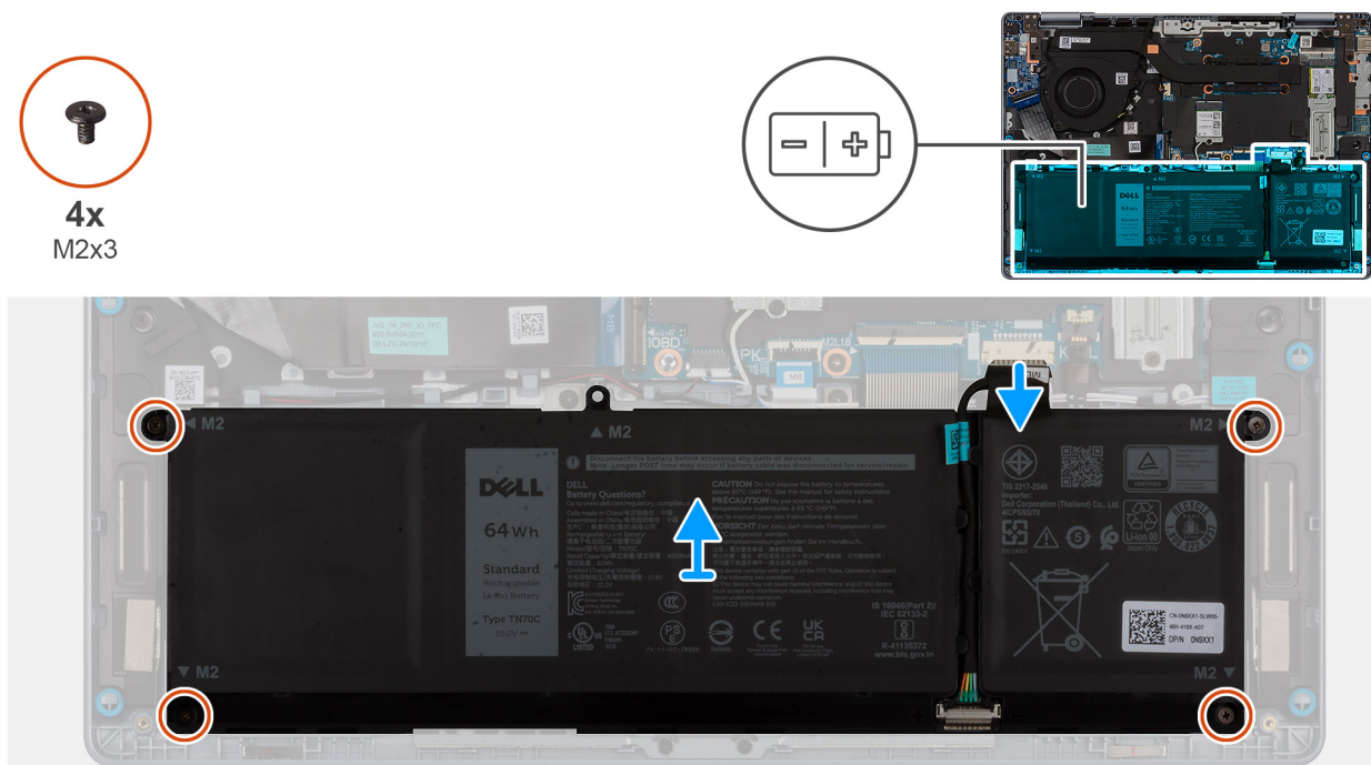
Rysunek 15. Wymontowywanie baterii
