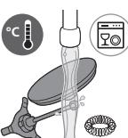
**3** Вийміть вінчик із тримача й промийте деталі гарячою проточною водою.
