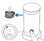
**5** Premete il pulsante per 1 secondo per riscaldare e montare il latte. Premete il pulsante per 3 secondi per montare il latte freddo.
