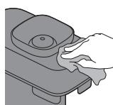
Çekirdek haznesinin içini ve makinenin dışını nemli bir bezle temizleyin. Çekirdek haznesini ve makinenin dışını kuru bir bezle kurulayın.
