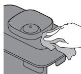
Vyčistěte vnitřek nádoby na kávová zrna a vnější část přístroje vlhkým hadříkem. Vysušte nádobu na kávová zrna a vnější část přístroje suchým hadříkem.
