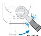
Funkcija direktnog pokretanja vam omogućava da jednostavno uključite aparat i skuvate ukusnu kafu. Nema dugmeta za uključivanje/isključivanje. Samo pritisnite dugme napitka koji želite da skuvate. Zatim pomjerite portafilter udesno da biste pokrenuli postupak mljevenja i kuvanja.
