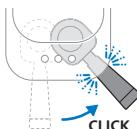
La función de inicio directo le permite encender su máquina y preparar un delicioso café fácilmente. No hay botón de activado/desactivado. Simplemente pulse el botón de la bebida que desee preparar. A continuación, mueva el portafiltros a la derecha para iniciar la molienda y el proceso de preparación del café.
