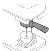
**7** Kafijas aparāts uzsilst un sāk skalot ūdeni tasē caur kafijas tekni. Šī procesa laikā intensitātes palielināšanas poga joprojām lēni mirgo.
