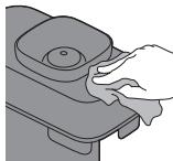
Nettoyez l'intérieur du bac à grains et l'extérieur de la machine avec un chiffon humide.
