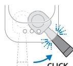
Funkcija direktnog početka omogućava vam da uključite aparat i lako spremite ukusnu kafu. Ne postoji dugme za uključivanje/isključivanje. Prosto pritisnite dugme napitka koji želite da skuvate. Zatim pomerite portafilter udesno da biste započeli proces mlevenja i kuvanja.
