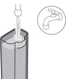
3 冲洗水箱。向水箱中注入纯净水，然后将其重新放入咖啡机中。
