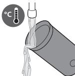
**1** Промийте спінювач молока зсередини гарячою проточною водою.
