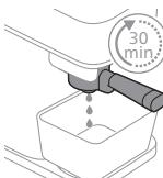
**6** Urządzenie dozuje cały roztwór odkamieniający w regularnych odstępach czasu. Trwa to do 30 minut.
