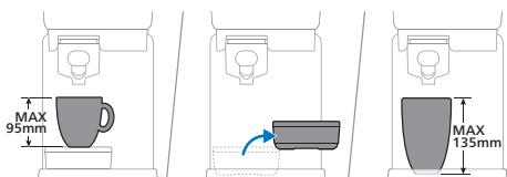
Kada je posuda za sakupljanje tečnosti na aparatu, možete da stavite šolju visine do 95 mm. Možete ukloniti posudu za sakupljanje tečnosti da napravite dodatni prostor za više šolje ili čaše. Ako se posuda za sakupljanje tečnosti ukloni, možete postaviti šolju visine do 135 mm.
