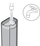
**4** Izskalojiet ūdens tvertni. Piepildiet ūdens tvertni ar svaigu ūdeni un ievietojiet to atpakaļ aparātā.
