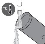
**1** Исплакнете ја внатрешноста на апаратот за млечна пена под млаз жешка вода.
