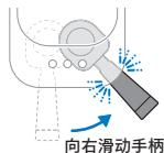
向右划动手柄，您可以轻松启动咖啡机并冲煮美味的咖啡。无单独的开/关按钮。只需按下您想要冲煮饮品的相应按钮即可。然后将冲煮手柄移到右侧，开始研磨和冲煮过程。
