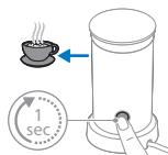
5 Houd de knop 1 seconde ingedrukt voor het verwarmen en opschuimen van melk. Houd de knop 3 seconden ingedrukt voor het opschuimen van koude melk.
