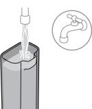
4 冲洗水箱。向水箱中注入纯净水，然后将其重新放入咖啡机中。
