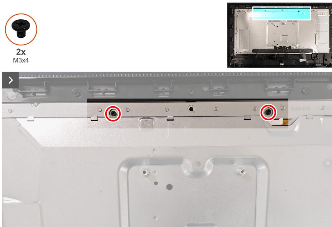
**Figura 19. Installazione del telaio in metallo**
