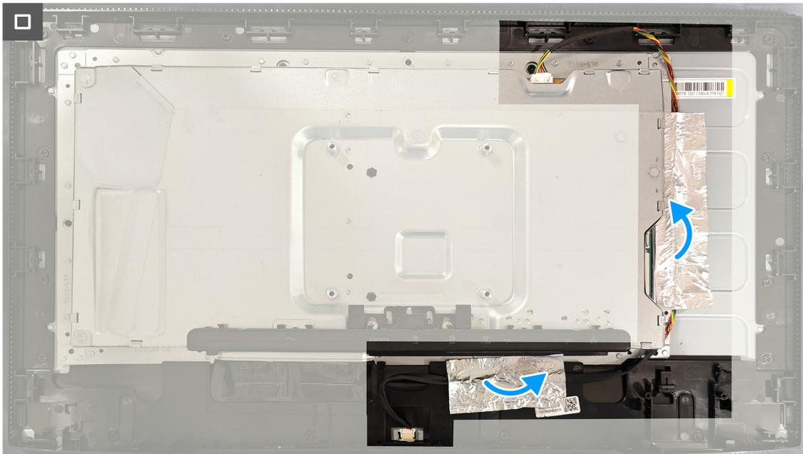
**Figura 21.** Installazione del telaio in metallo
