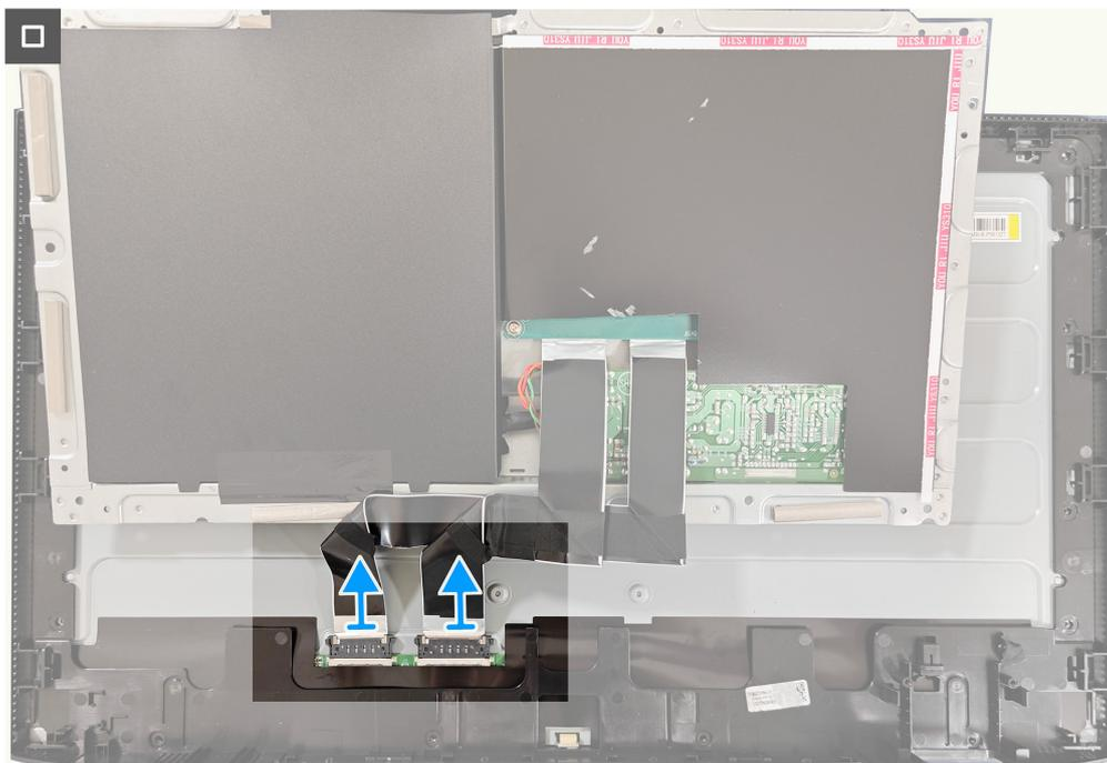
**Figura 16.** Rimozione del telaio in metallo
