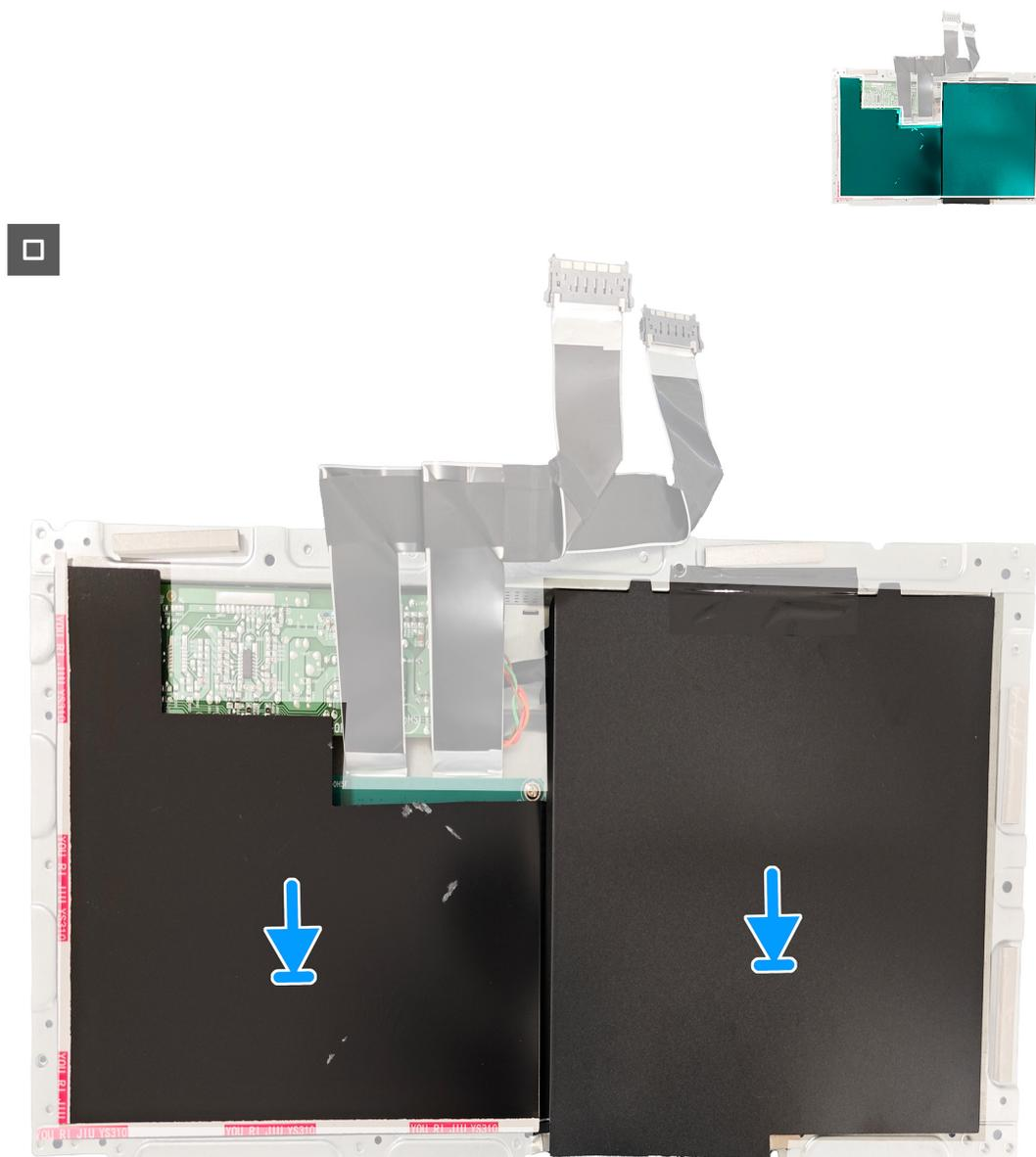
**Figura 27.** Installazione della scheda di sistema e della scheda di alimentazione
