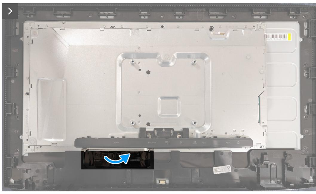
**Figura 15. Rimozione del telaio in metallo**
