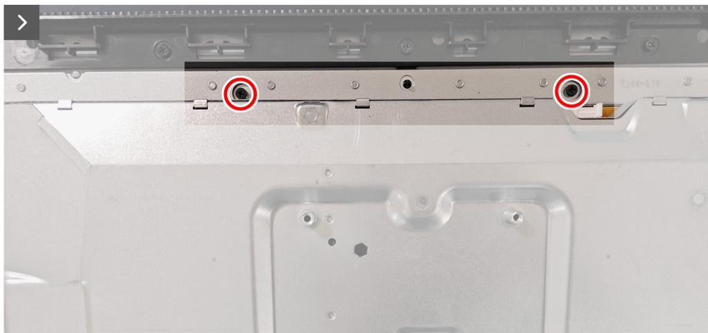
**Figura 14. Rimozione del telaio in metallo**
