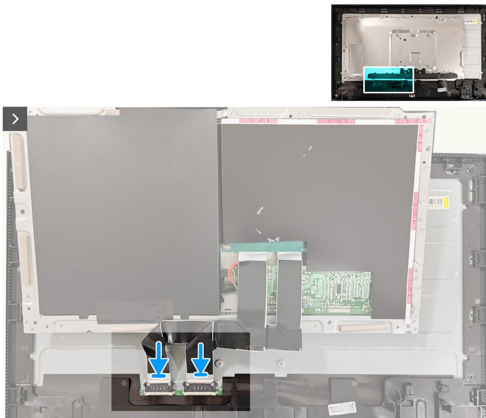
**Figura 17.** Installazione del telaio in metallo
