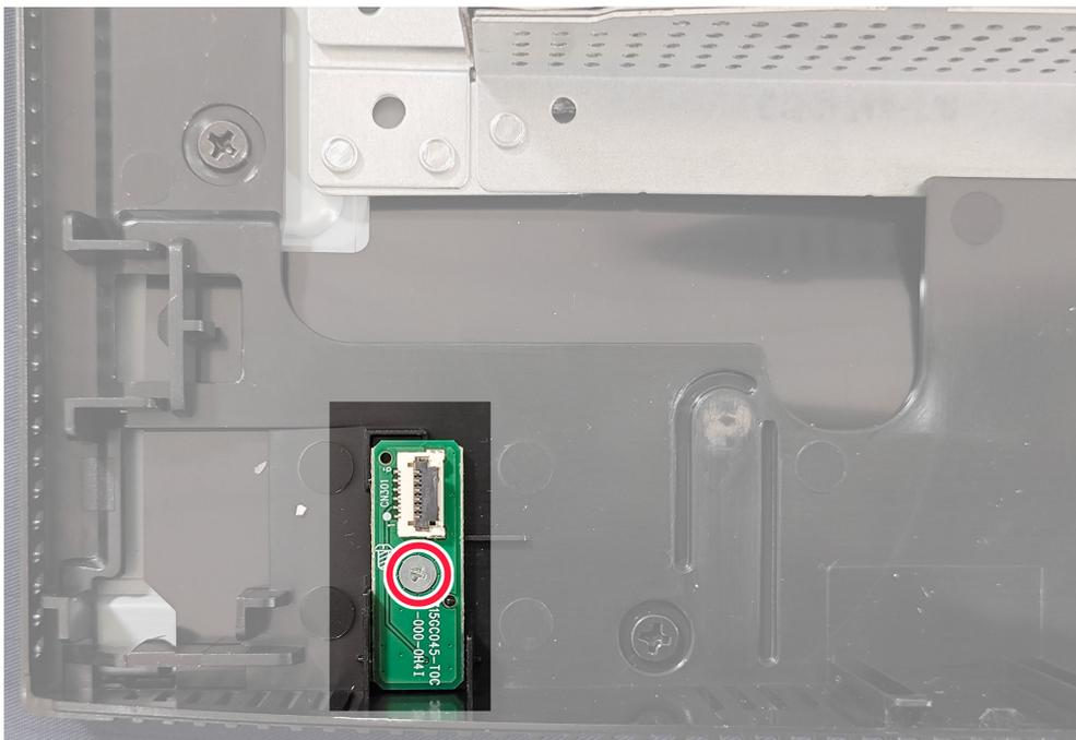
**Figura 10.** Installazione della scheda LENS
