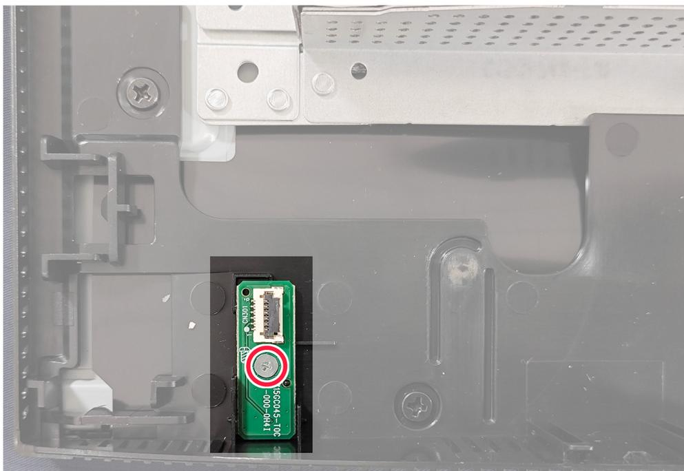
**Figura 9. Rimozione della scheda LENS**
