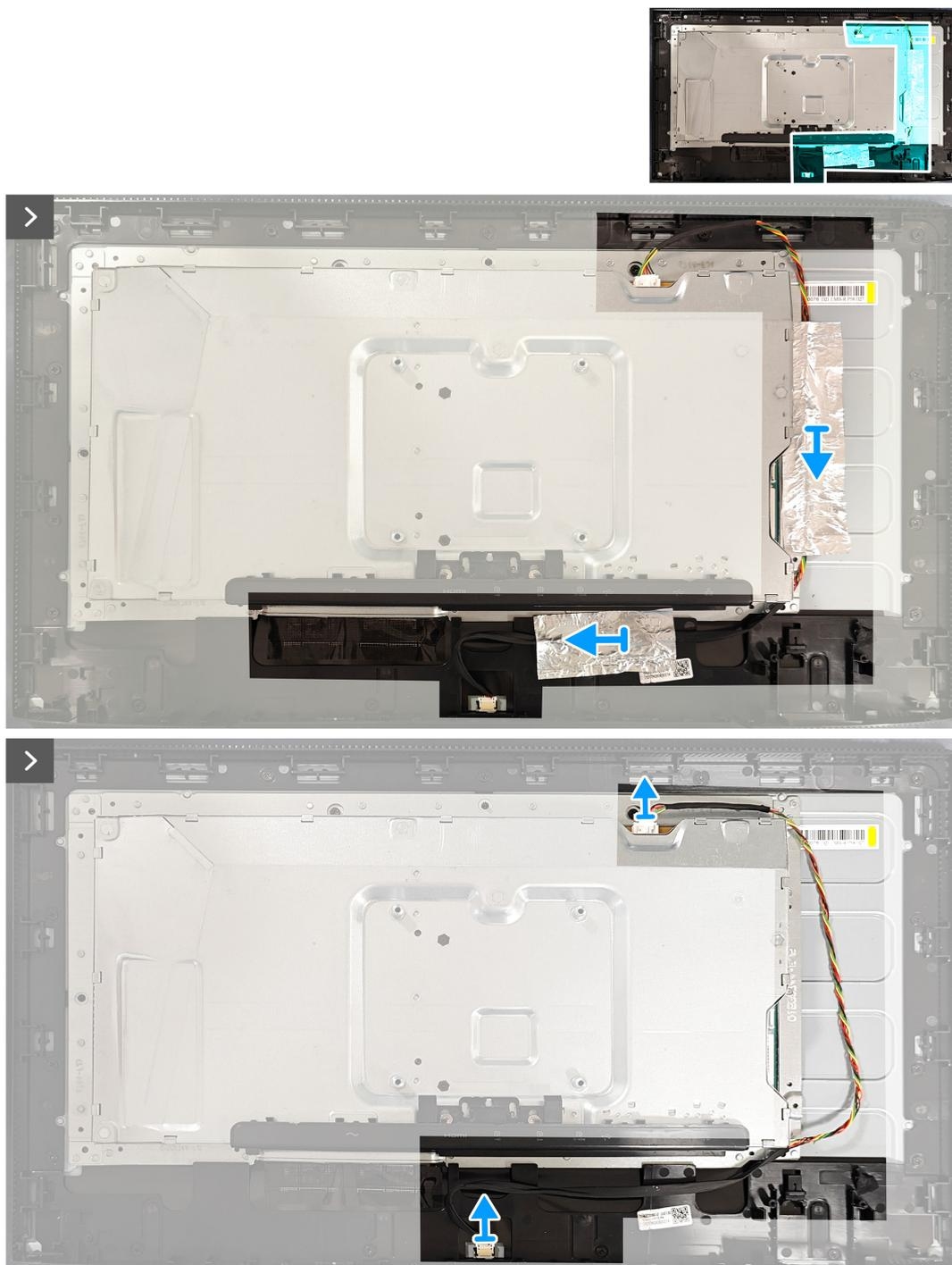
**Figure 24. Enlever le châssis métallique**
