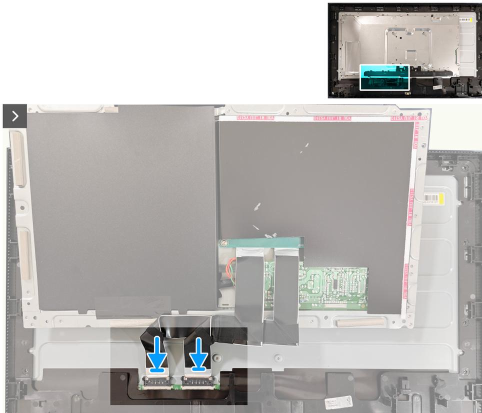
**Figure 28.** Installer le châssis métallique
