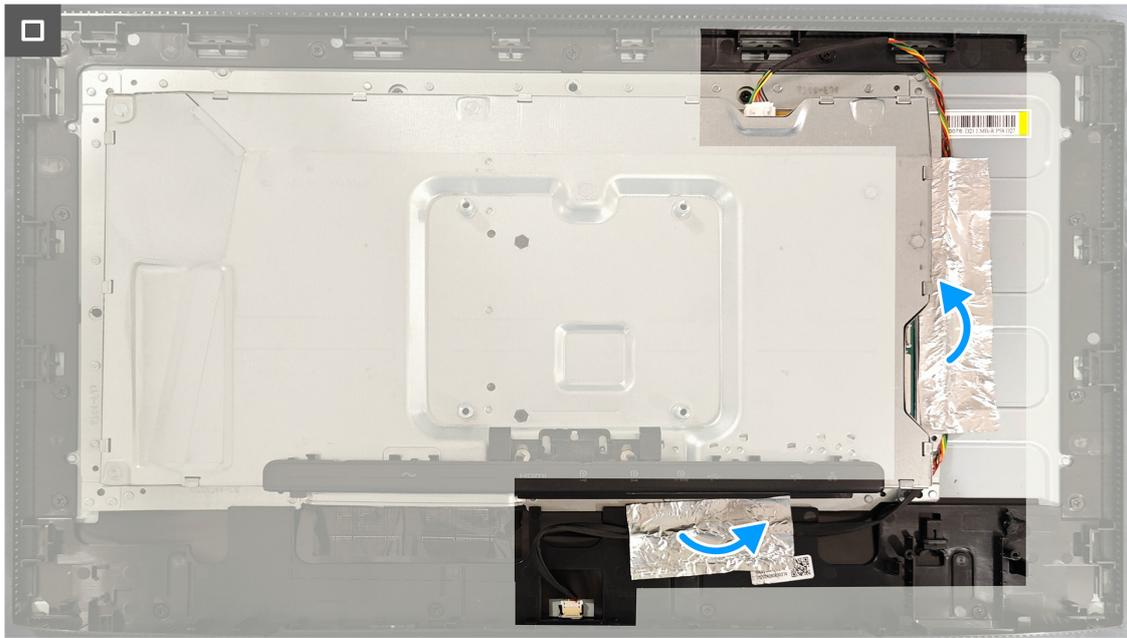
**Figure 32.** Installer le châssis métallique
