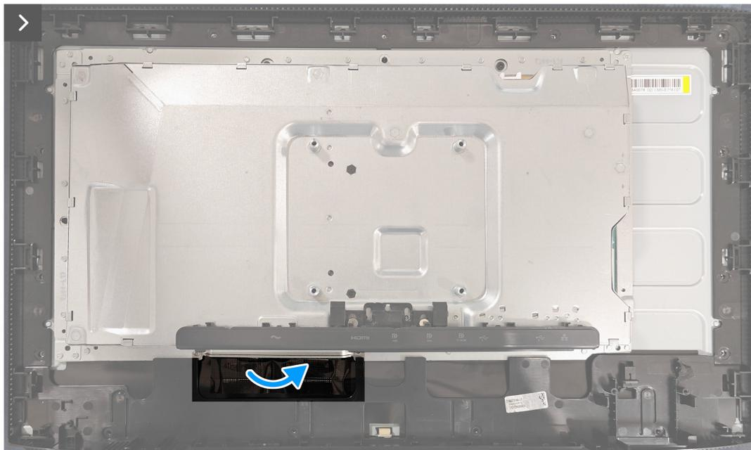
**Figure 29.** Installer le châssis métallique
