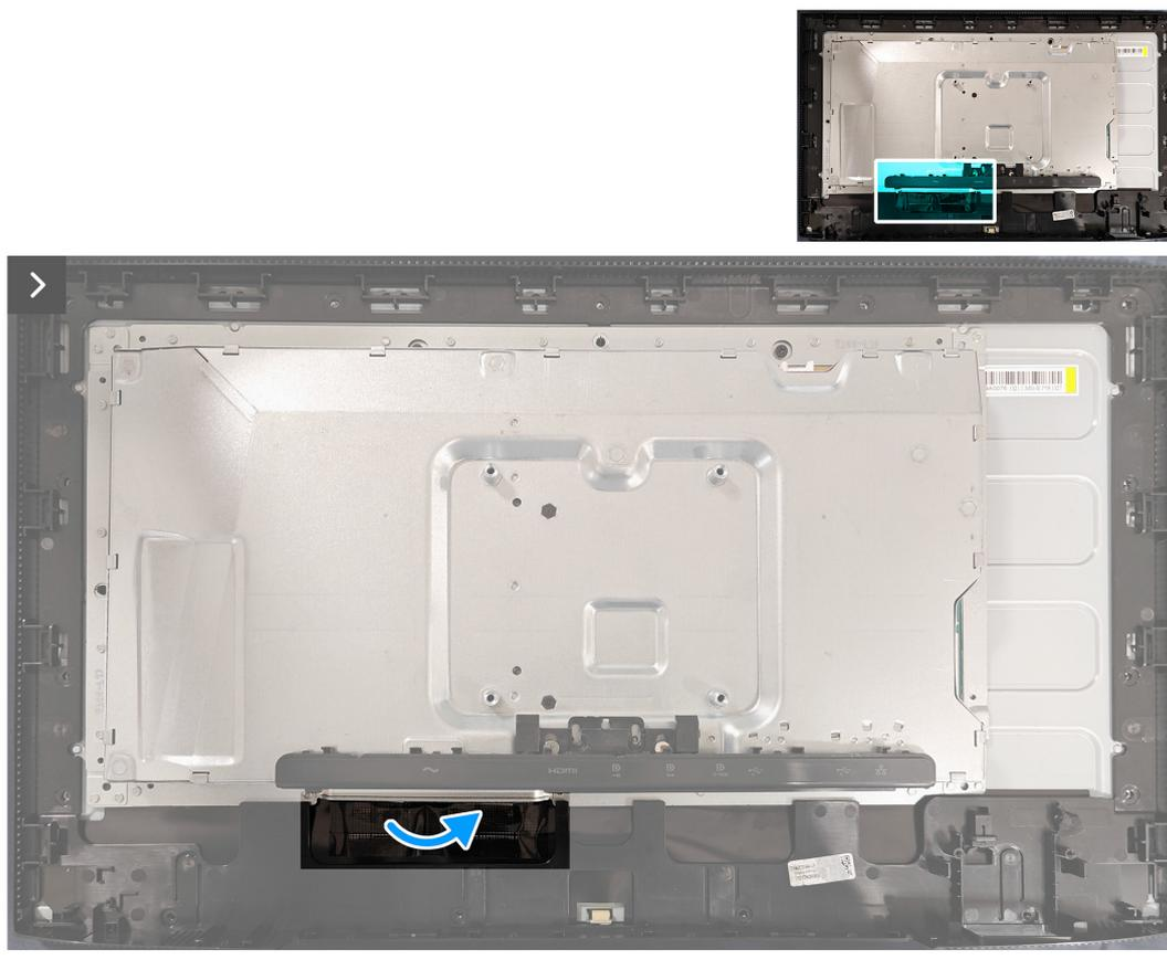
**Figure 26. Enlever le châssis métallique**
