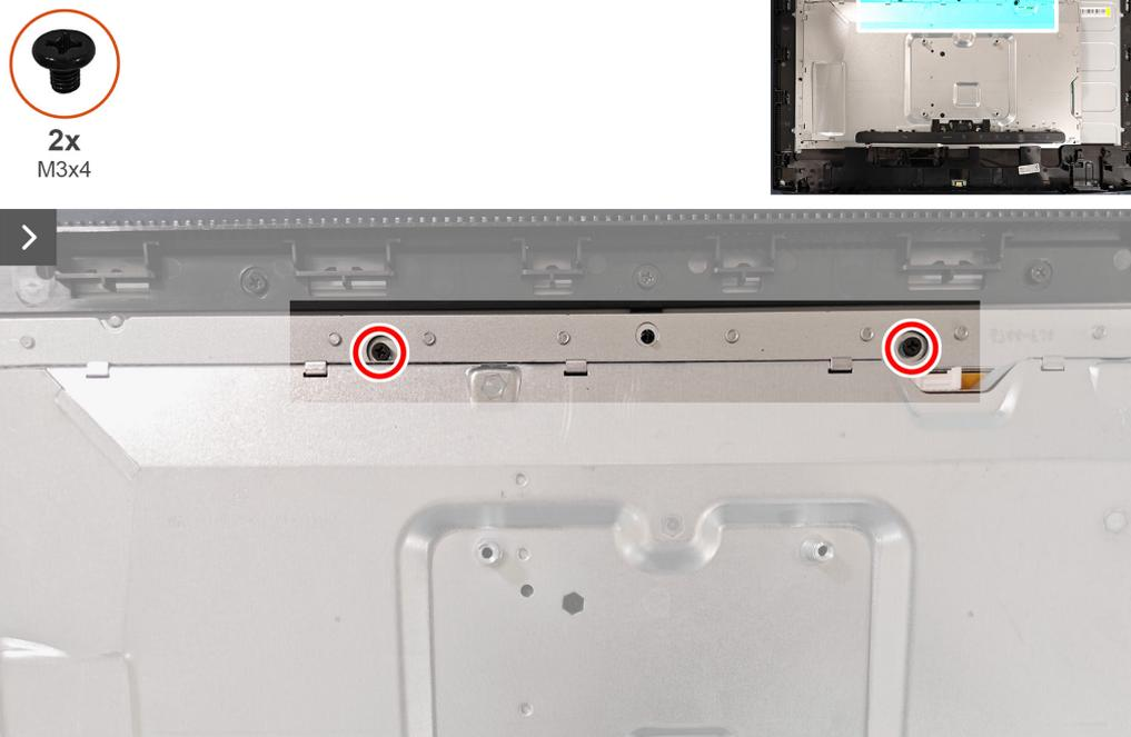
**Figure 25. Enlever le châssis métallique**
