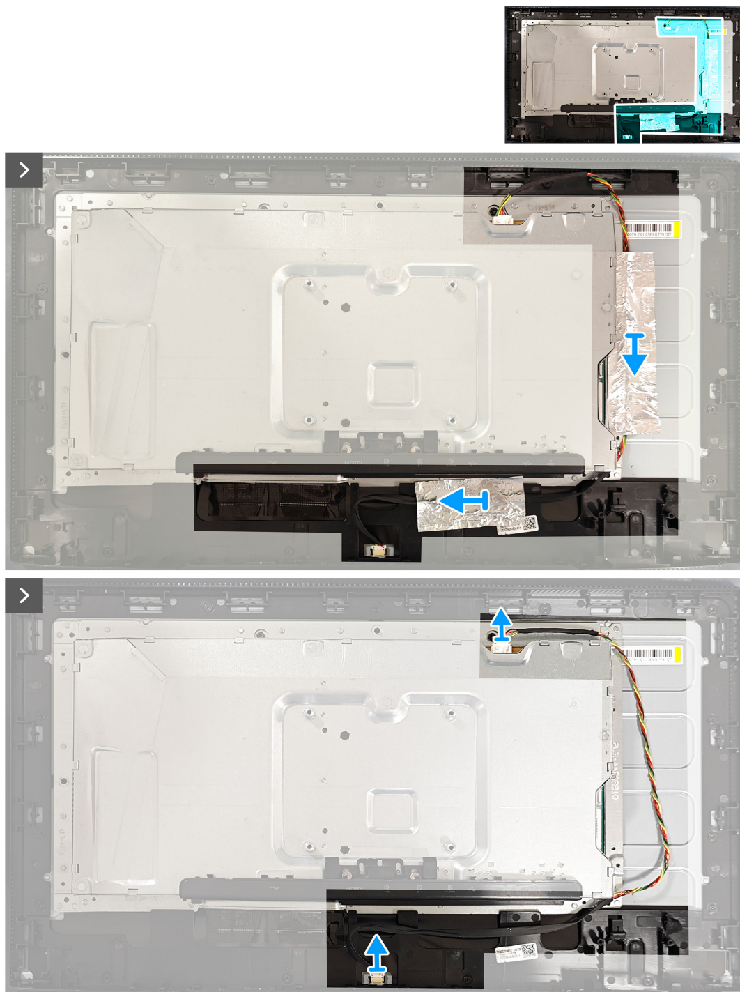
Figura 24. Remover a estrutura metálica
