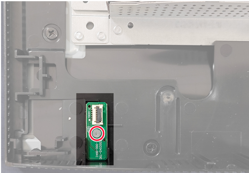
Figura 21. Instalar a placa LENS
