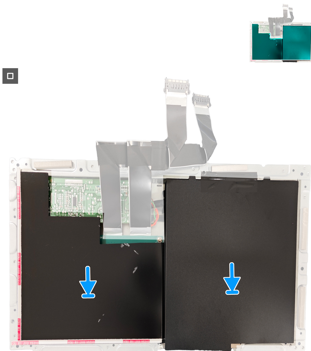
Figura 38. Instalar a placa do sistema e a placa de alimentação
