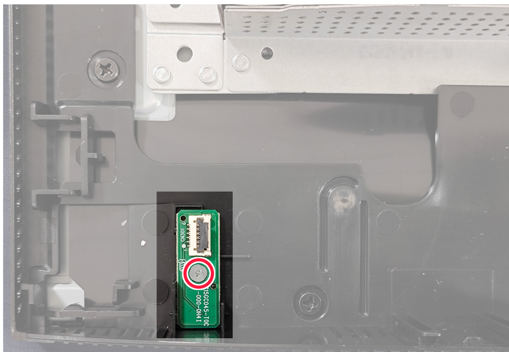
Figura 20. Remover a placa LENS
