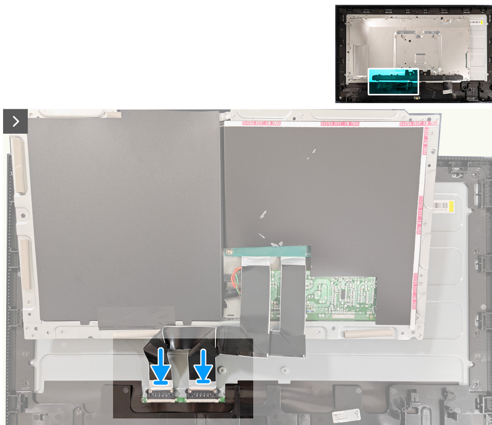
Figura 28. Instalar a estrutura metálica
