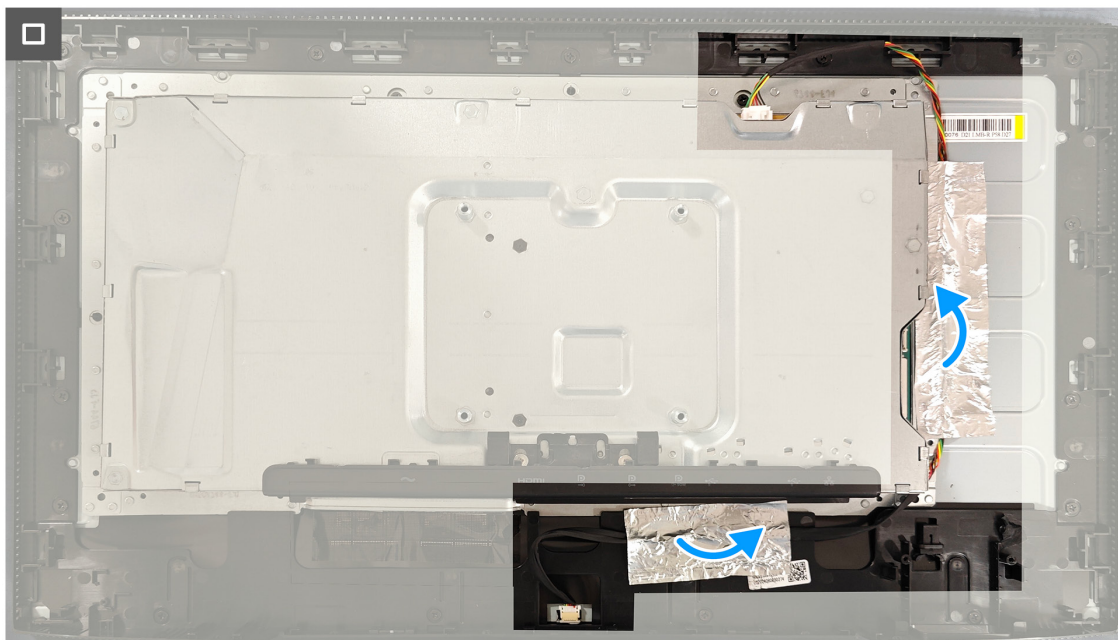
Figura 32. Instalar a estrutura metálica
