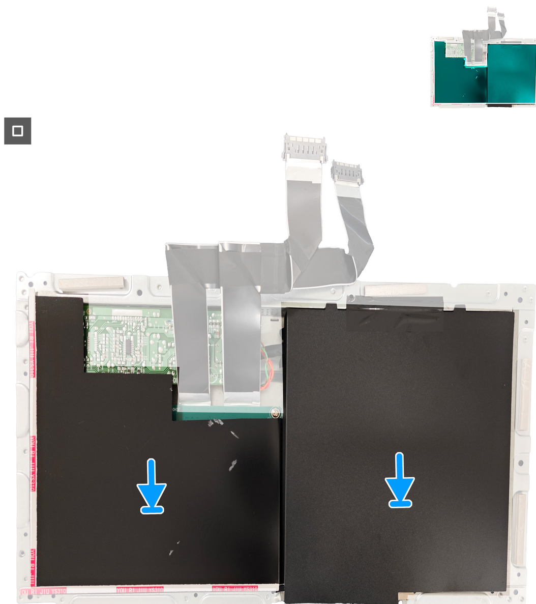
Figura 27. Instalar a placa do sistema e a placa de alimentação
