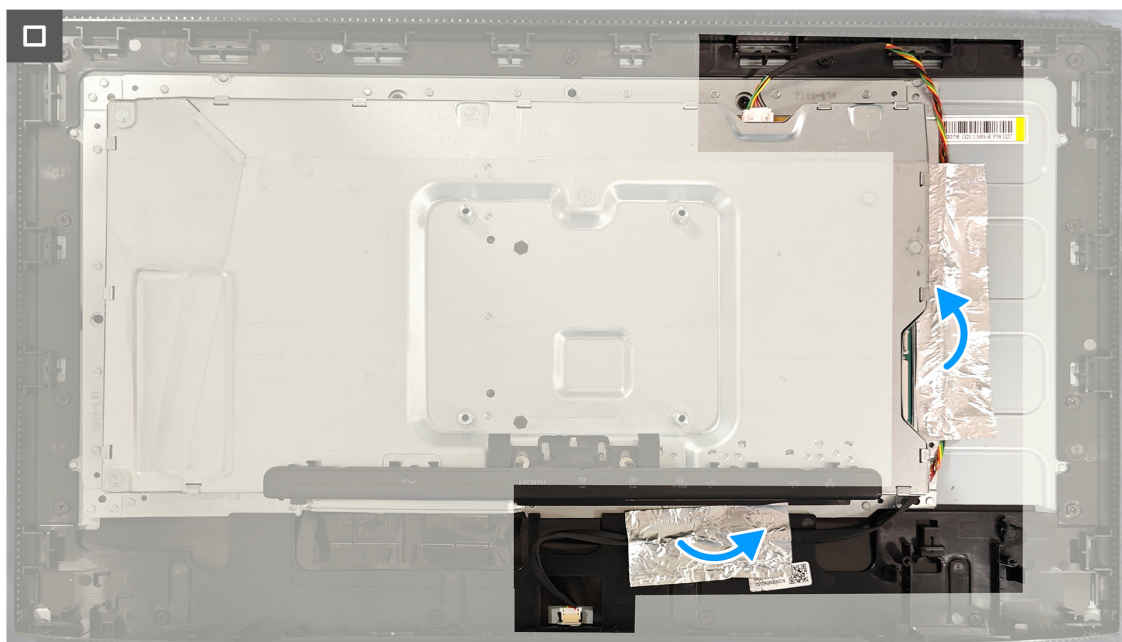
Figura 21. Instalar a estrutura metálica
