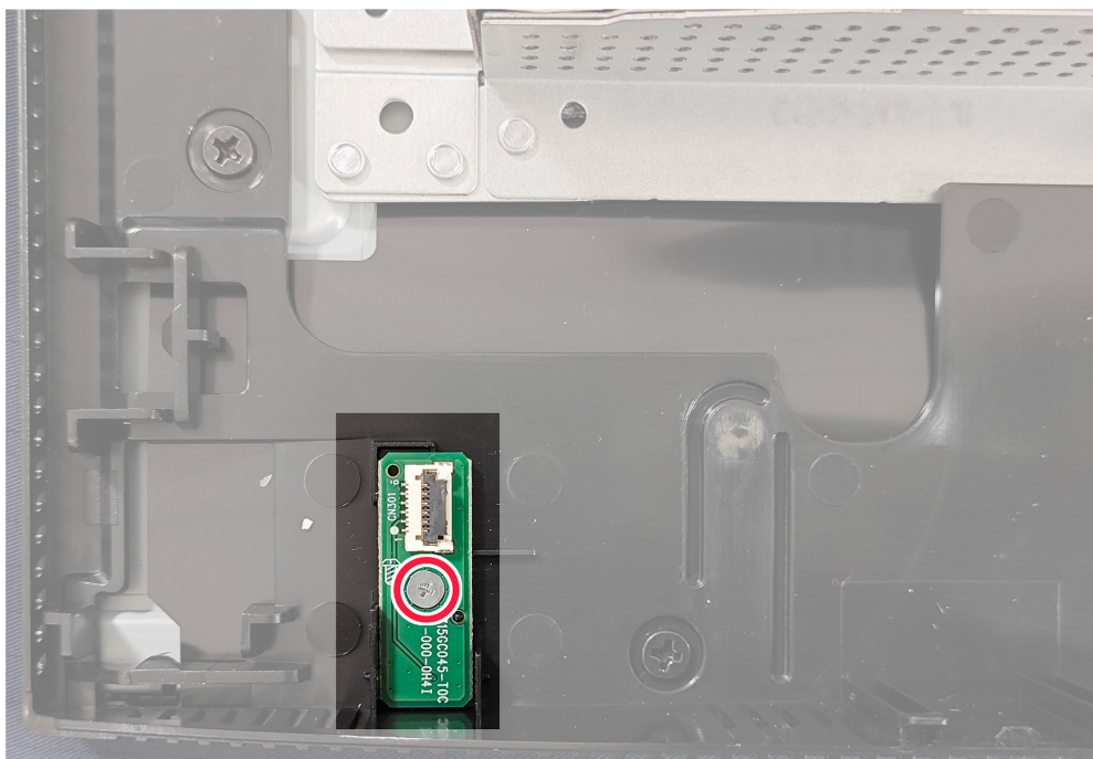
Figura 9. Remover a placa LENS
