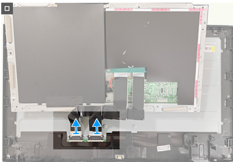
Figura 16. Remover a estrutura metálica
