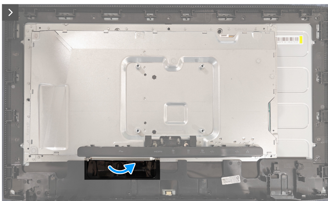
Figura 29. Installazione del telaio in metallo
