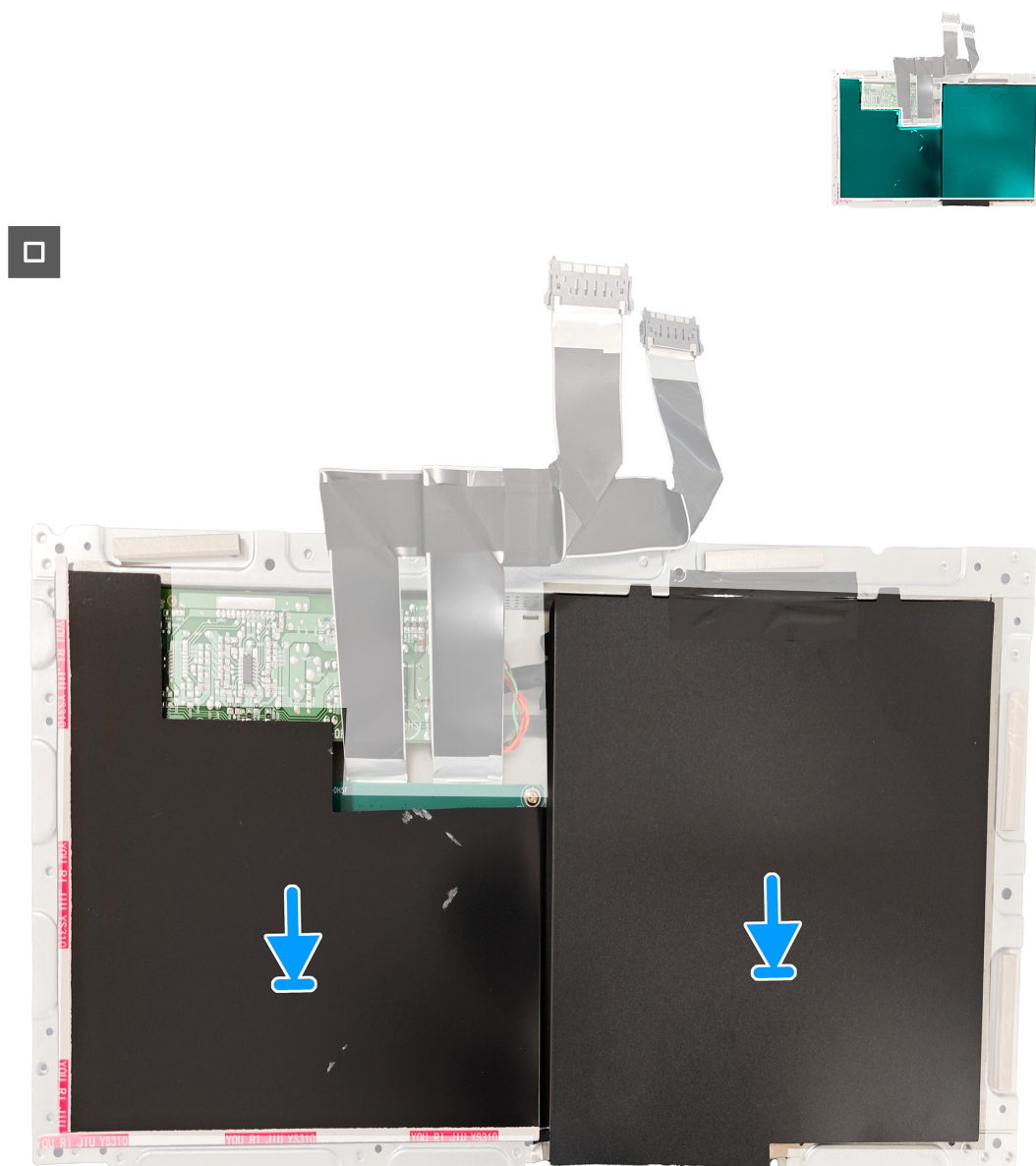
Figura 38. Installazione della scheda di sistema e della scheda di alimentazione
