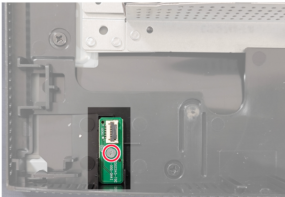
Figura 20. Rimozione della scheda LENS
