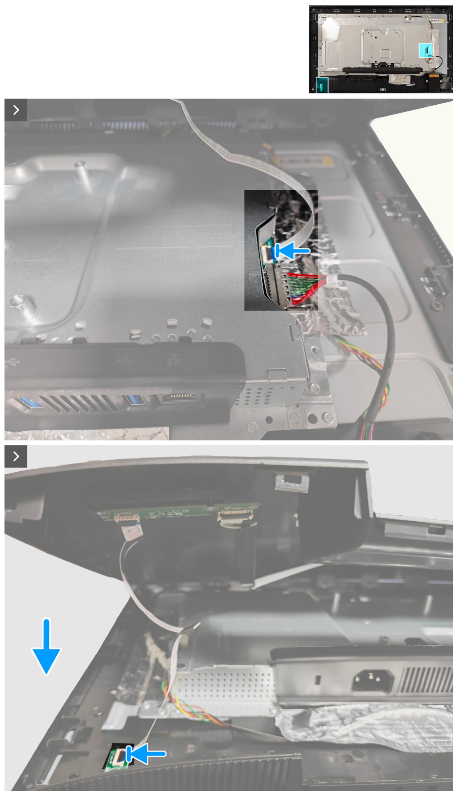
Figura 16. Installazione del coperchio posteriore
