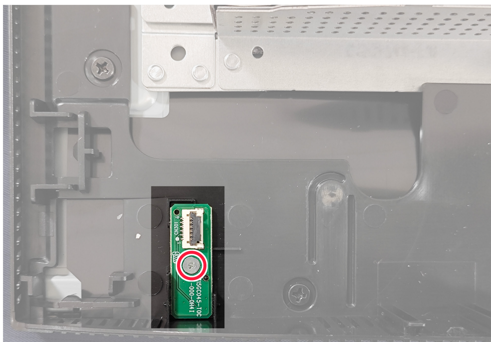
Figura 21. Installazione della scheda LENS
