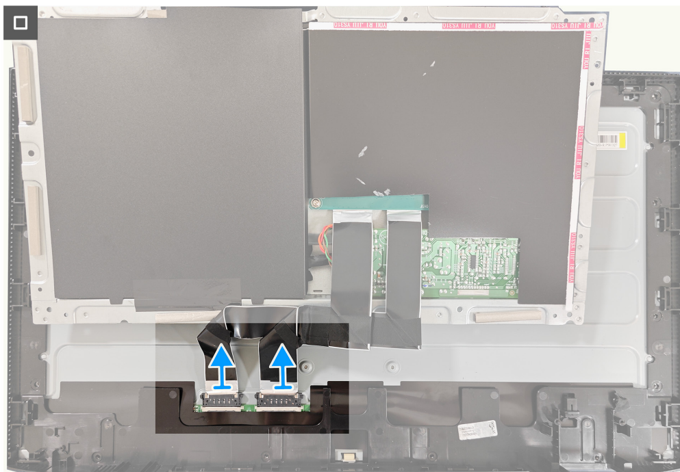
Figura 16. Retirar el marco metálico
