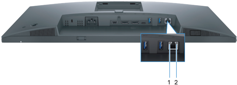
Figura 10. Estado do LED do conector RJ45
