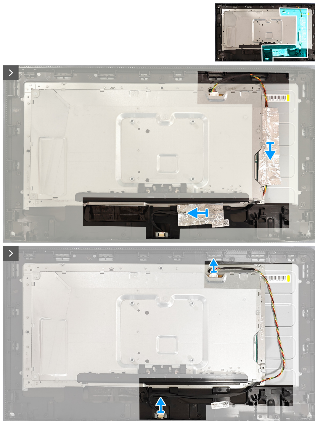
Rysunek 13. Zdejmowanie metalowej ramki
