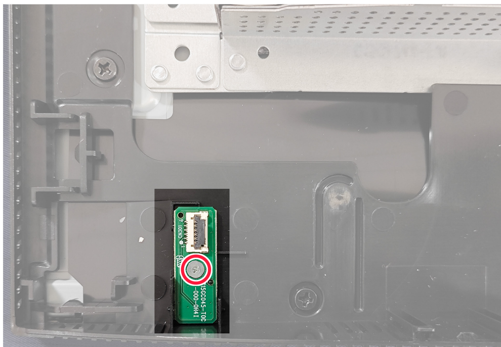
Figura 20. Retirar la placa LENS
