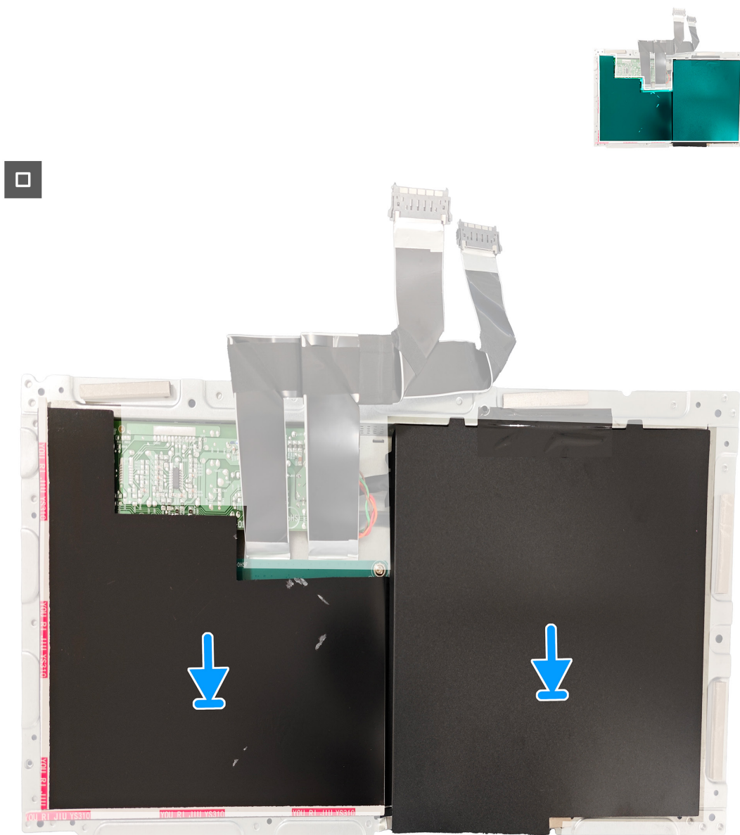
Figura 38. Instalar la placa del sistema y la placa de alimentación
