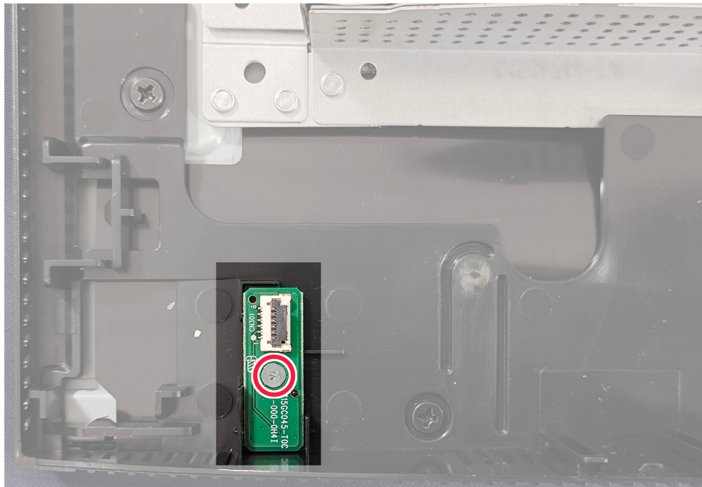
Figura 21. Instalar la placa LENS
