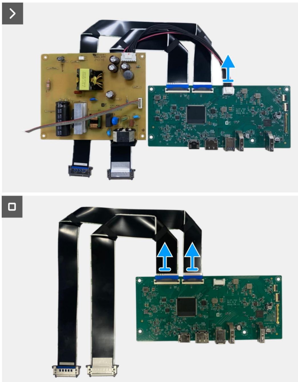
Figura 38. Rimozione della scheda di interfaccia
