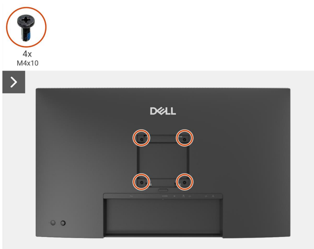
Figura 82. Rimozione della copertura posteriore
