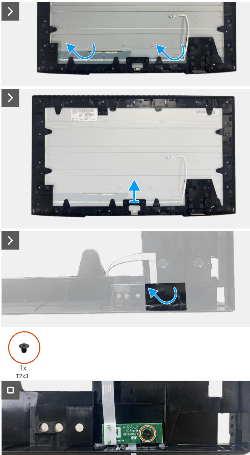
Figura 75. Rimozione della scheda LED
