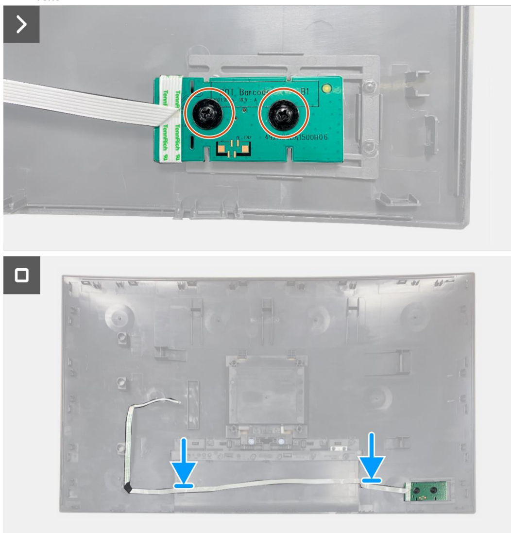
Figure 27. Installation de la carte clavier
