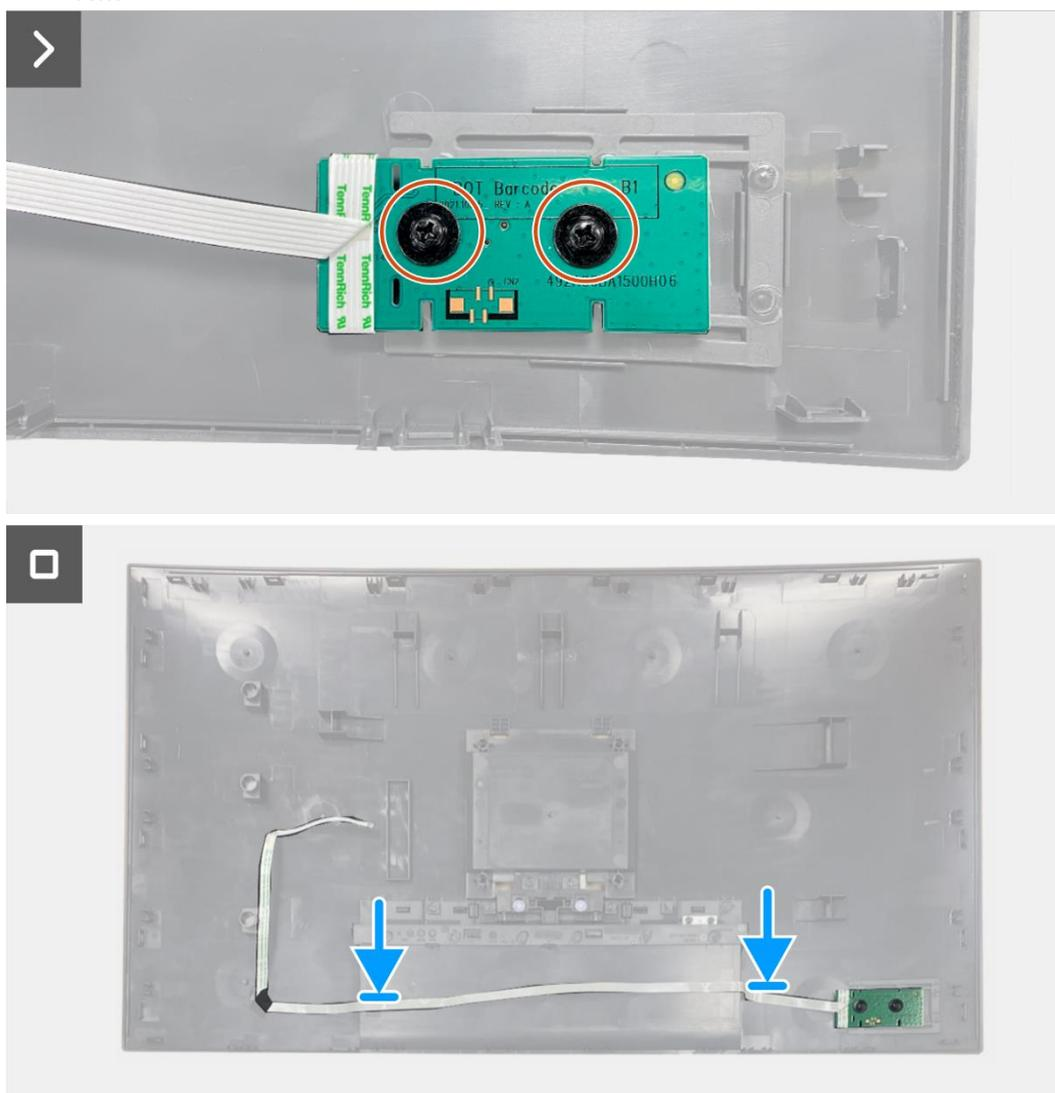
**Figura 70.** Installazione della scheda della tastiera
