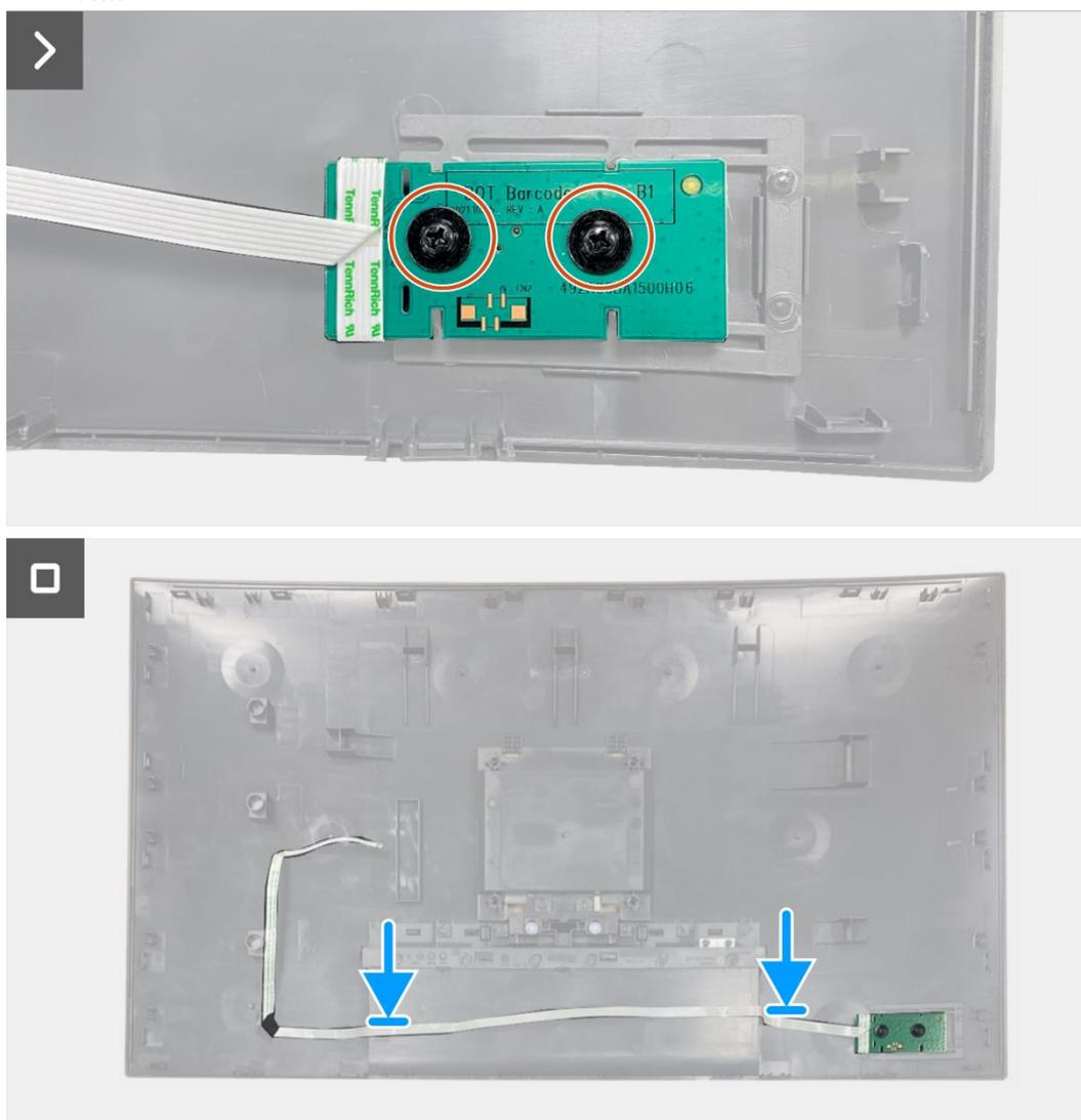
**Figura 10.** Installazione della scheda della tastiera
