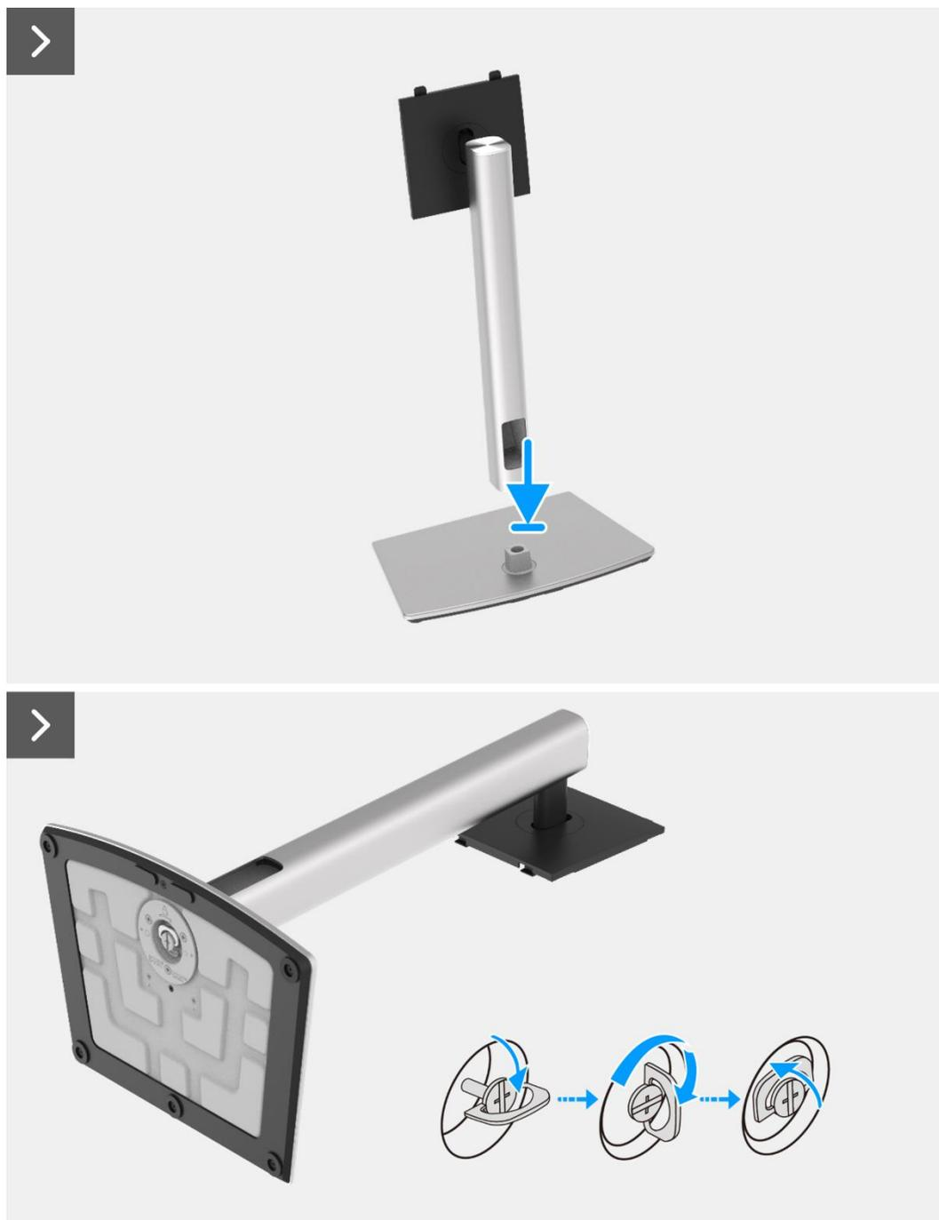
Figura 63. Installazione del supporto
