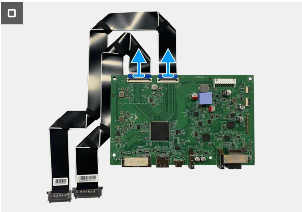
**Figura 51.** Rimozione della scheda di interfaccia
