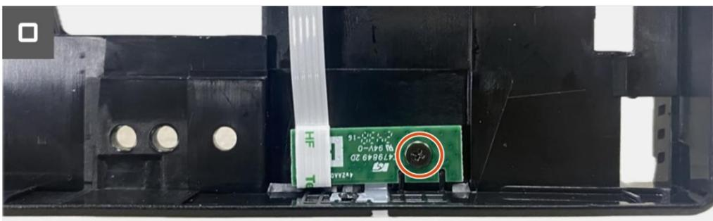
**Figura 28.** Rimozione della scheda LED
