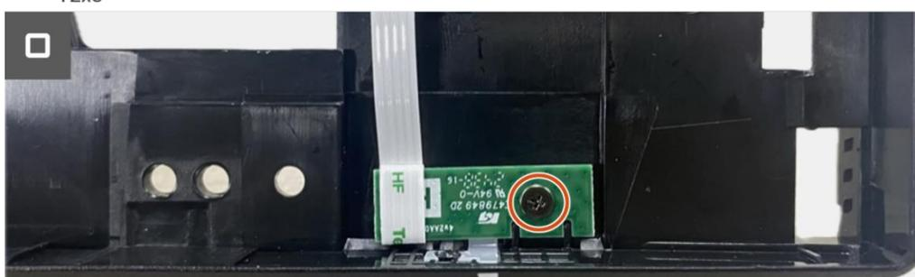
**Figura 88.** Rimozione della scheda LED
