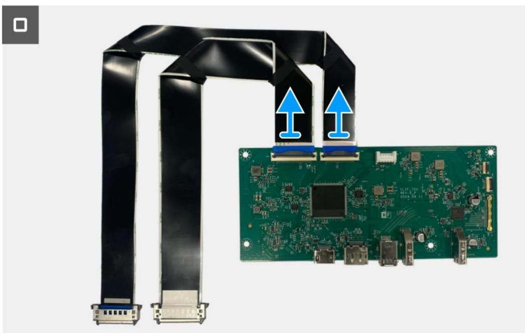
**Figura 21.** Rimozione della scheda di interfaccia
