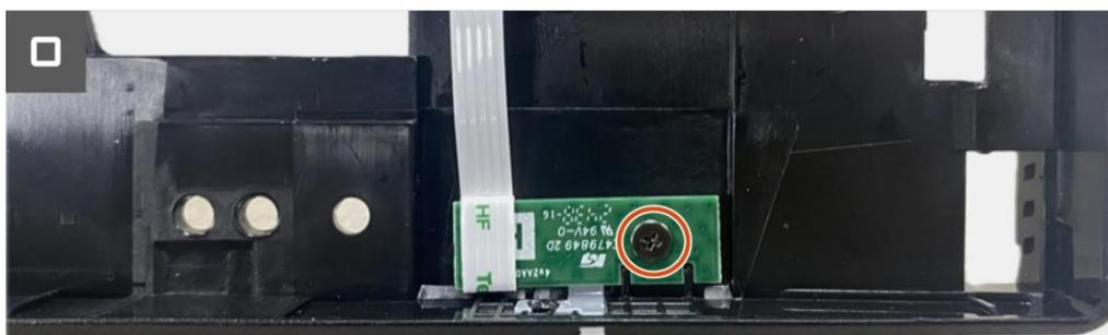
**Figura 58.** Rimozione della scheda LED
