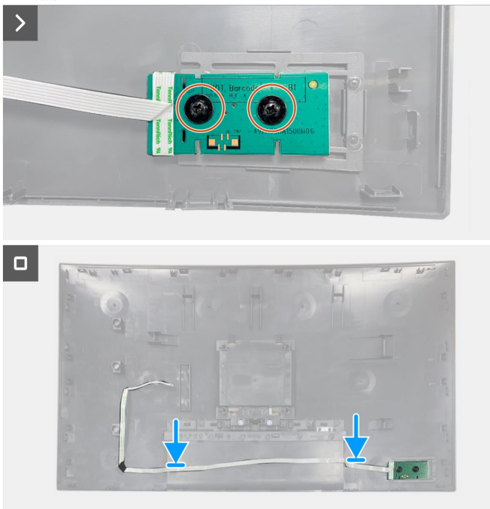
Obrázek 10. Instalace desky klávesnice
