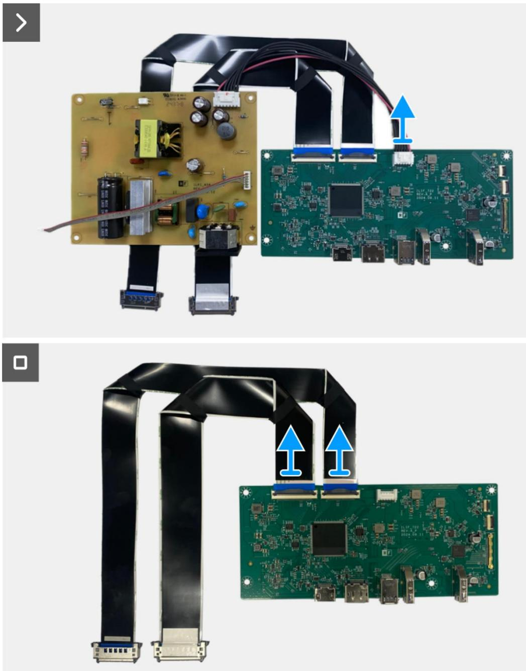
**Figura 38.** Remoção da placa de interface
