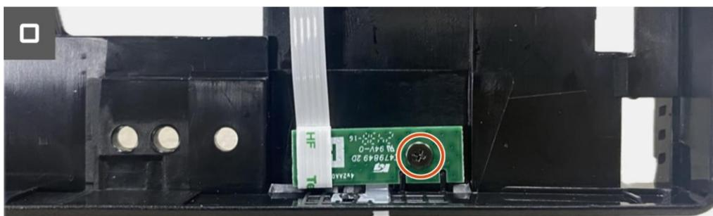
**Figura 75.** Remover a placa de LEDs
