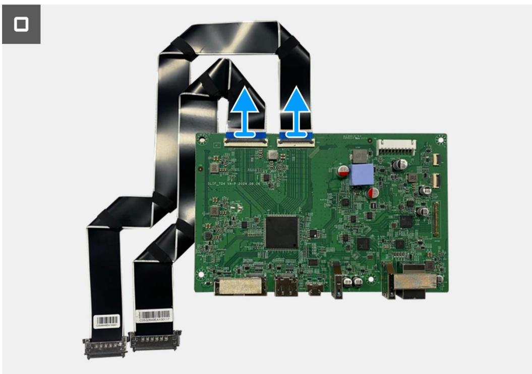
Figura 68. Remoção da placa de interface
