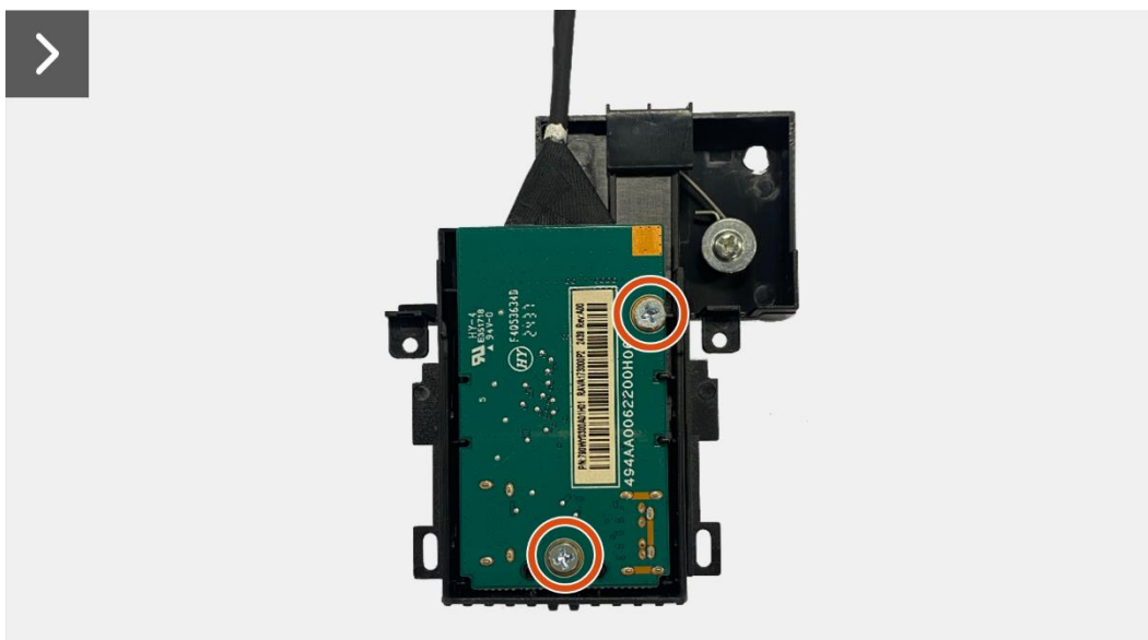
Imagen 13. Instalación de la placa QAP
