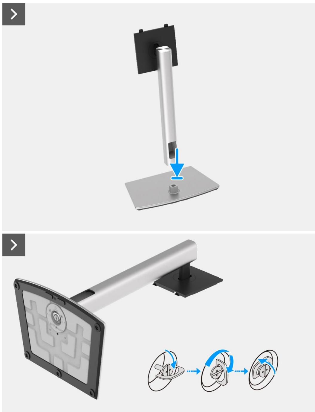
Imagen 63. Instalación del soporte
