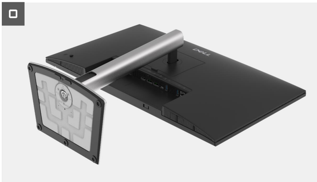
Imagen 4. Instalación del soporte
