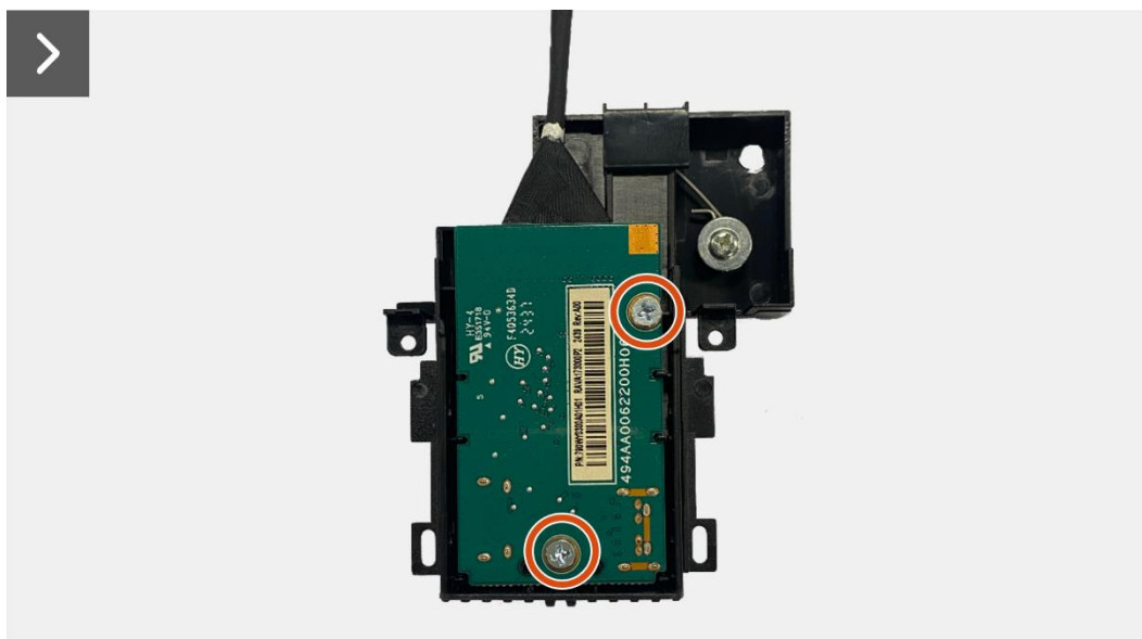
Imagen 73. Instalación de la placa QAP
