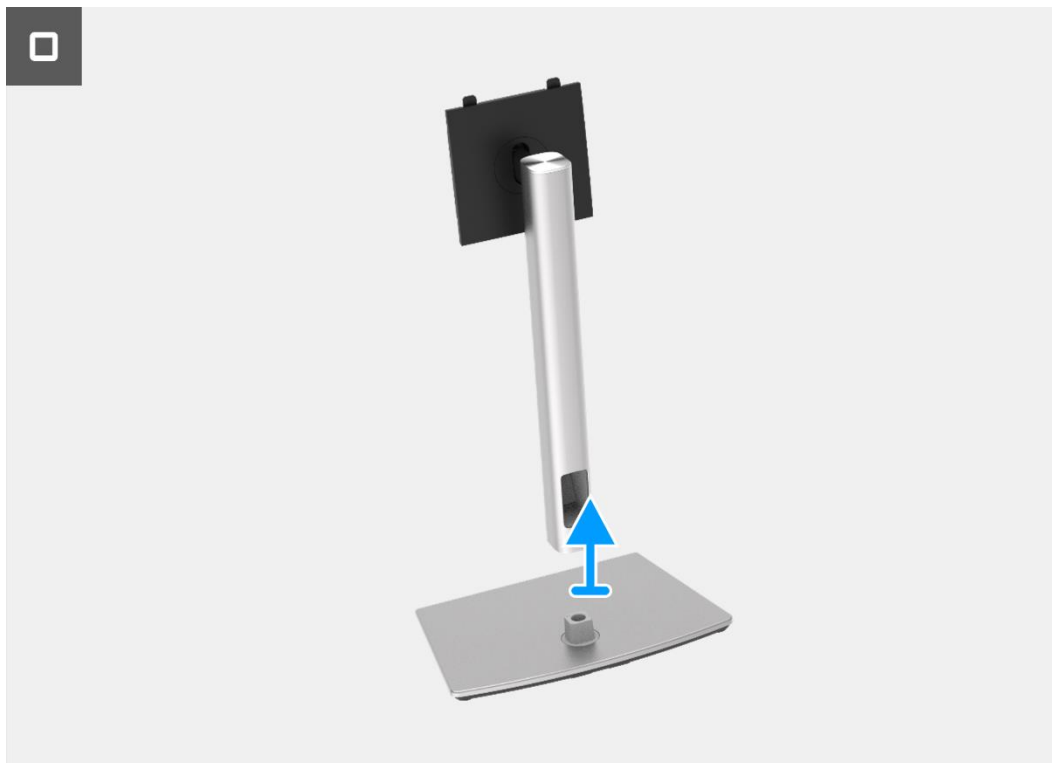
Imagen 32. Extracción del soporte
