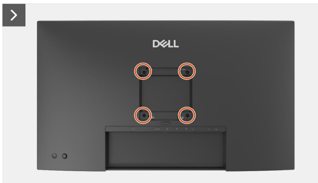
Imagen 35. Extracción de la cubierta trasera
