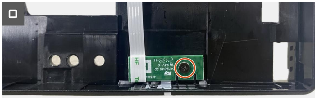
Imagen 28. Extracción de la placa LED
