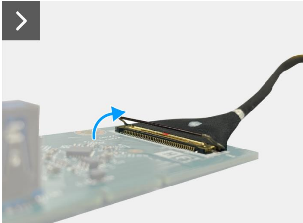
Imagen 42. Extracción de la placa QAP
