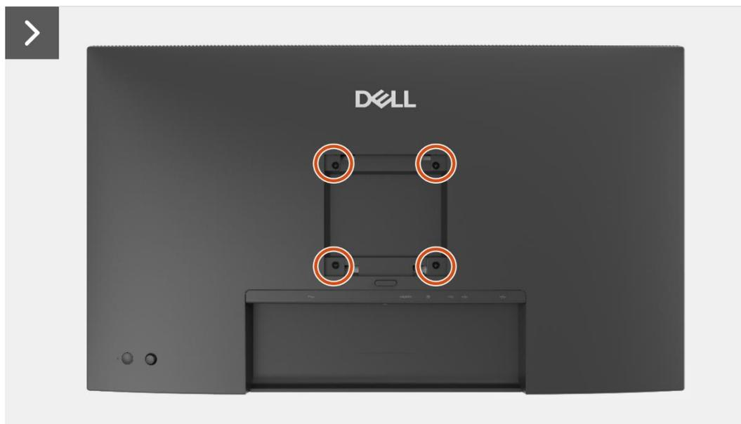
**Imagen 22.** Extracción de la cubierta trasera
