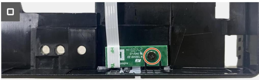
**Imagen 45.** Extracción de la placa LED
