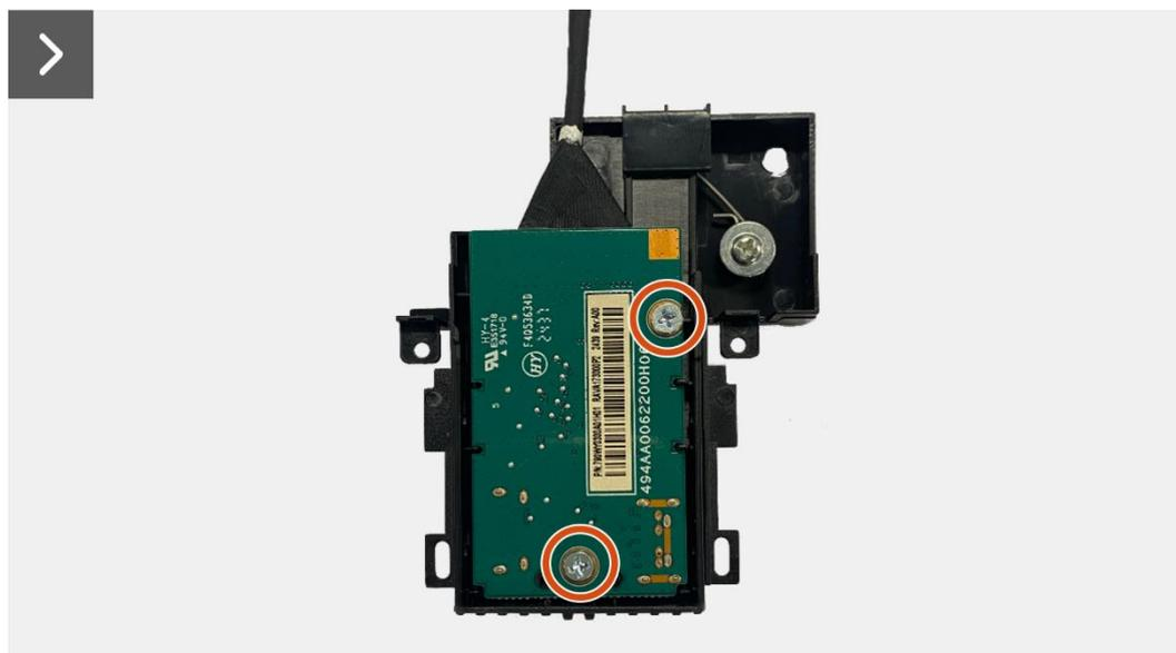
**Imagen 90.** Instalación de la placa QAP
