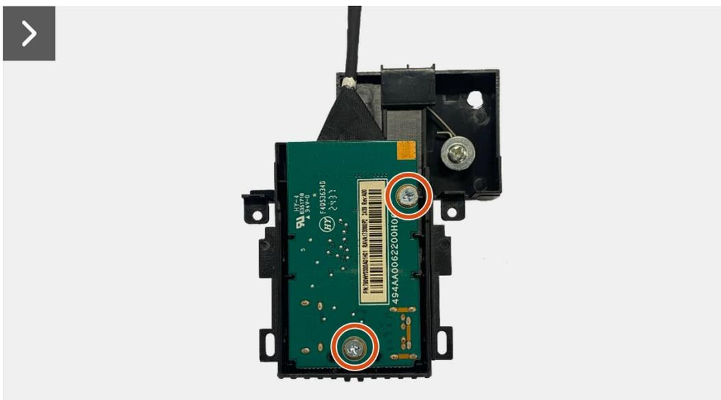
Imagen 30. Instalación de la placa QAP
