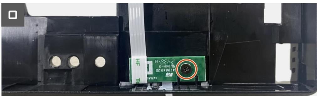
**Imagen 105.** Extracción de la placa LED
