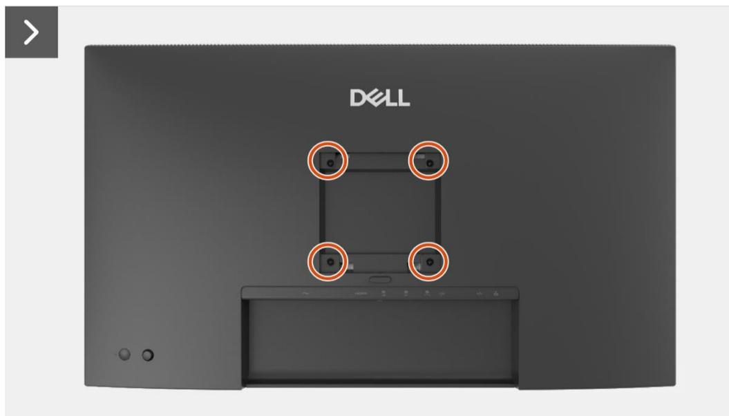
**Imagen 52.** Extracción de la cubierta trasera
