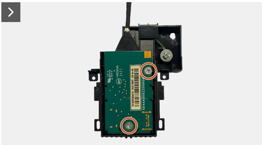
**Imagen 60.** Instalación de la placa QAP
