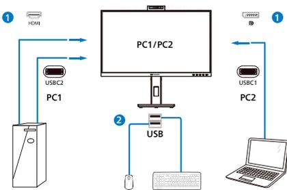
3. Rufen Sie das Bildschirmmenü auf. Rufen Sie die KVM-Ebene auf und wählen Sie zum Wechseln der Peripheriesteuerung von einem Gerät zum anderen „Auto“, „USB C1“ oder „USB C2“ (USB-Upstream). Wiederholen Sie diesen Schritt einfach, wenn Sie das Steuersystem über ein Set Peripheriegeräte umschalten möchten.
