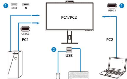
3. Rufen Sie das Bildschirmmenü auf. Rufen Sie die KVM-Ebene auf und wählen Sie zum Wechseln der Peripheriesteuerung von einem Gerät zum anderen „Auto“, „USB C1“ oder „USB C2“ (USB-Upstream). Wiederholen Sie diesen Schritt einfach, wenn Sie das Steuersystem über ein Set Peripheriegeräte umschalten möchten.
