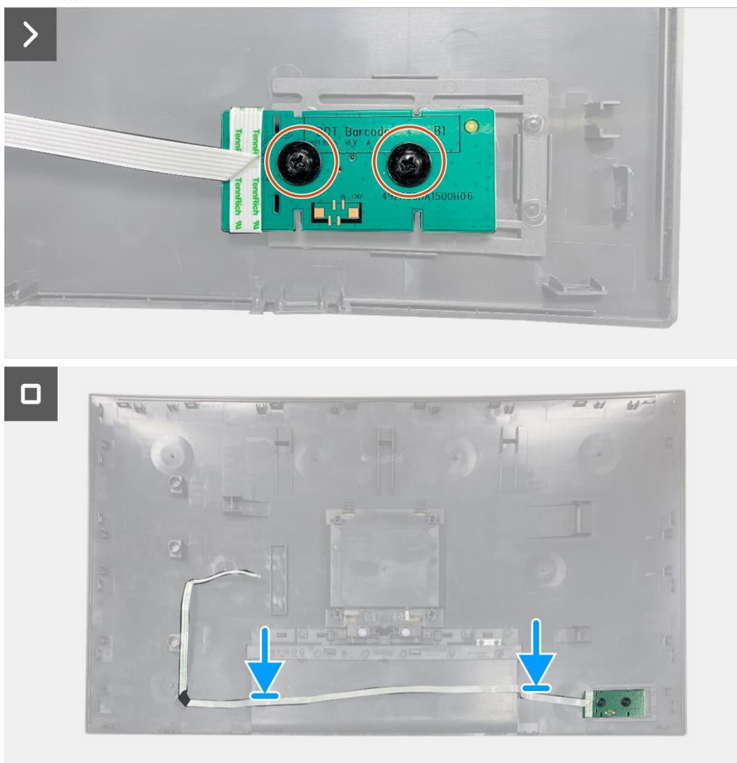
**Figure 27.** Installation de la carte clavier
