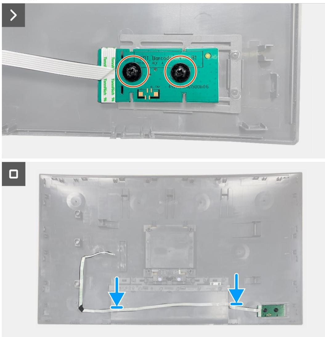
**Figure 87. Installation de la carte clavier**
