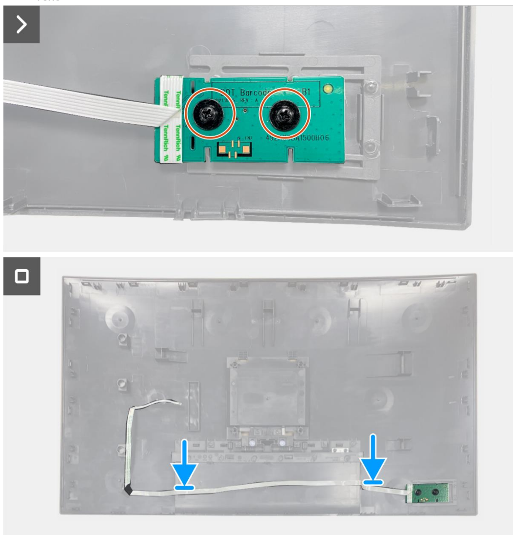
Figure 70. Installation de la carte clavier
