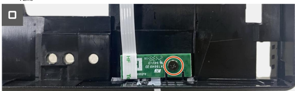
Imagen 105. Extracción de la placa LED
