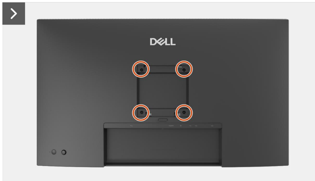
Imagen 5. Extracción de la cubierta trasera
