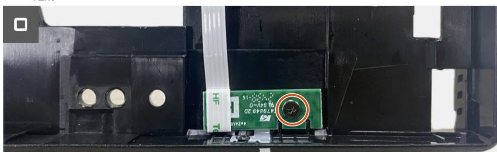
Imagen 58. Extracción de la placa LED
