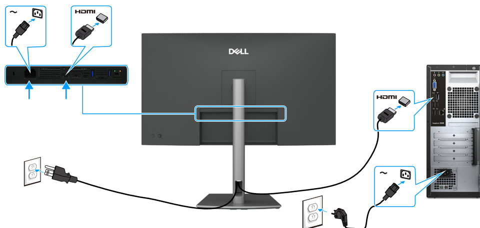
Figure 8. Branchement du câble HDMI
