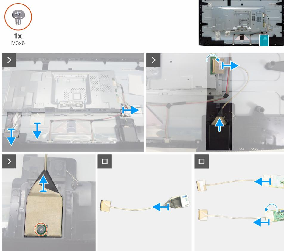
**Figura 5. Rimozione della scheda USB**
