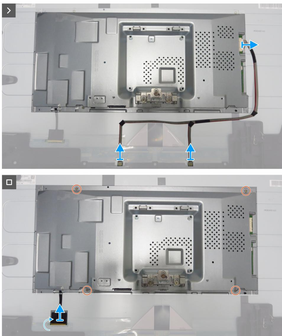
**Figura 6. Rimozione del telaio principale**
