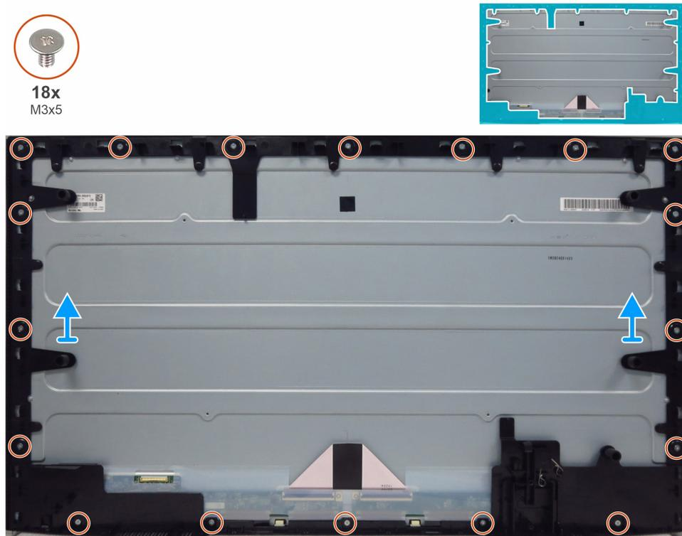
**Figura 7. Rimozione del telaio centrale**
