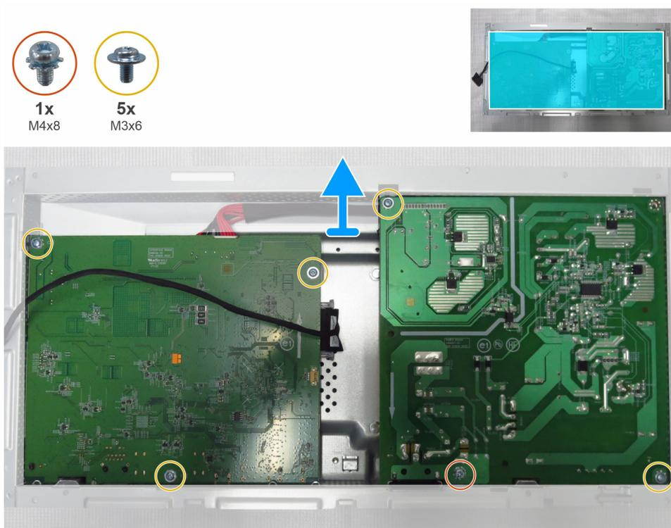
**Figura 9. Rimozione della scheda principale e della scheda di alimentazione**
