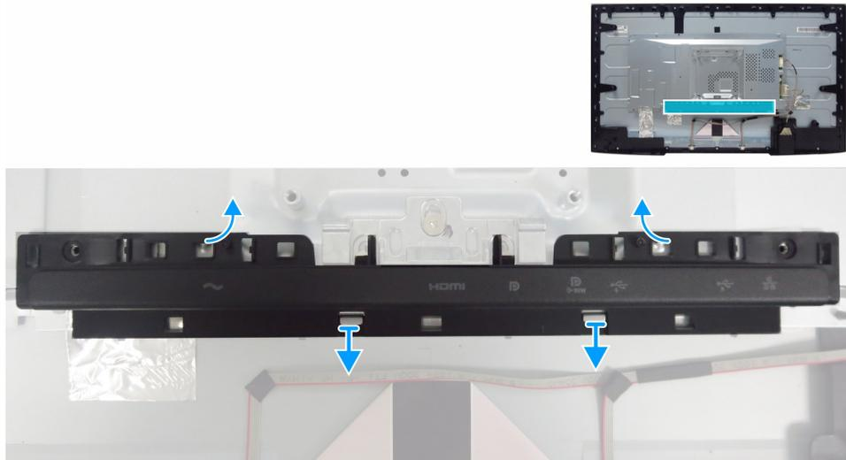
**Figura 4.** Rimozione della copertura delle interfacce I/O
