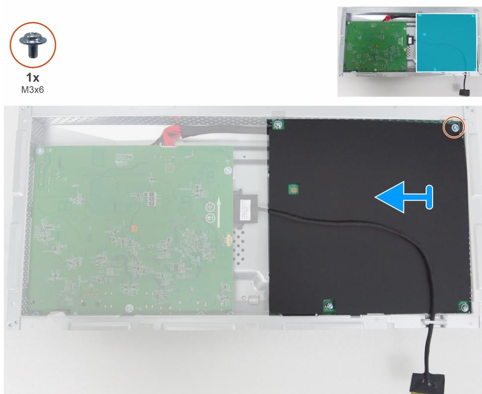
**Figura 8. Rimozione del foglio di Mylar**
