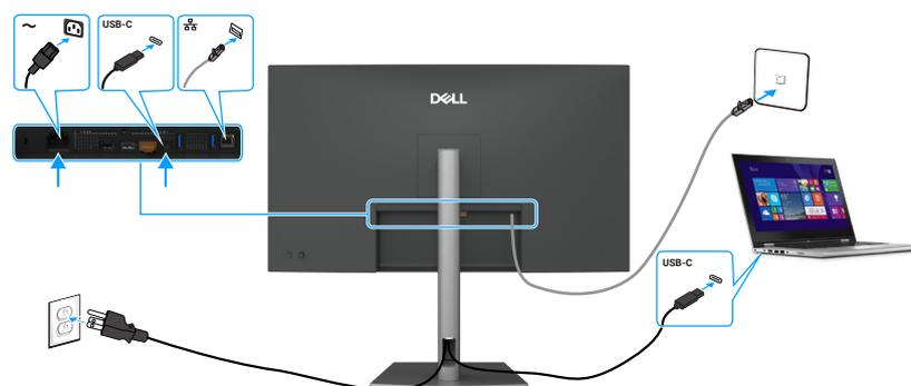
**Figure 34.** Connexion du moniteur avec un câble RJ45
