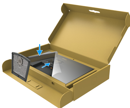
Figura 20. Insira as patilhas do braço de elevação nas ranhuras
