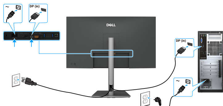
Rysunek 29. Podłączenie kabla DisplayPort
