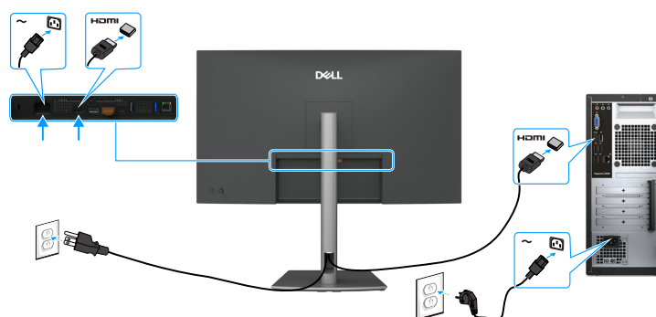
Rysunek 28. Podłączenie kabla HDMI
