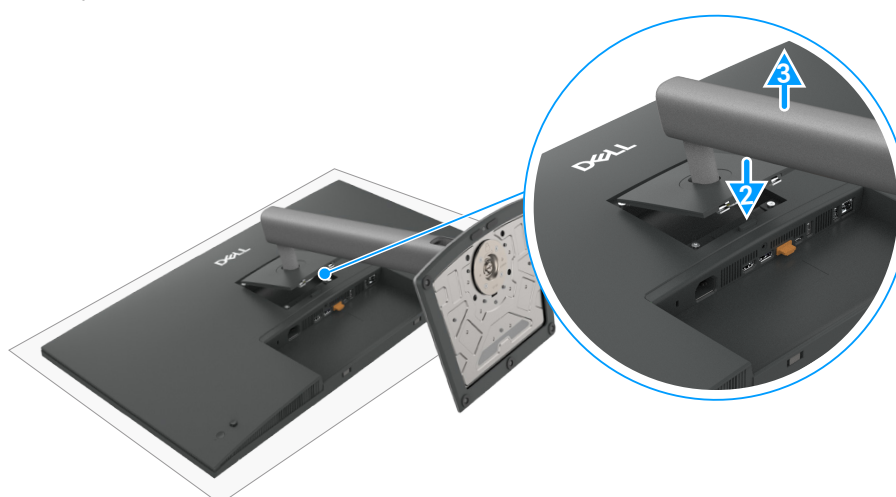
Rysunek 55. Demontaż podstawy monitora
