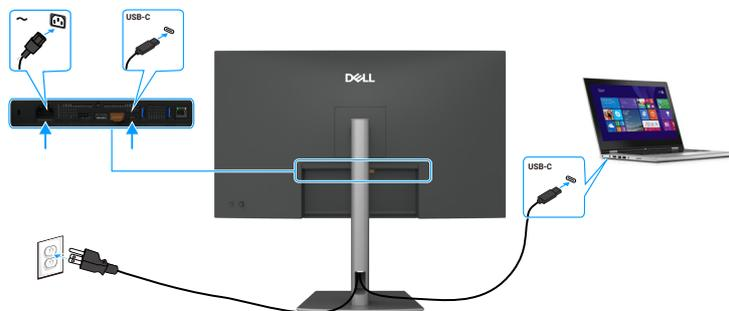
**Figura 31.** Conectar el cable USB-C a C
