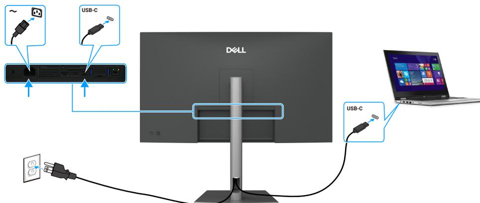
Figura 10. Conexión del cable USB-C a C
