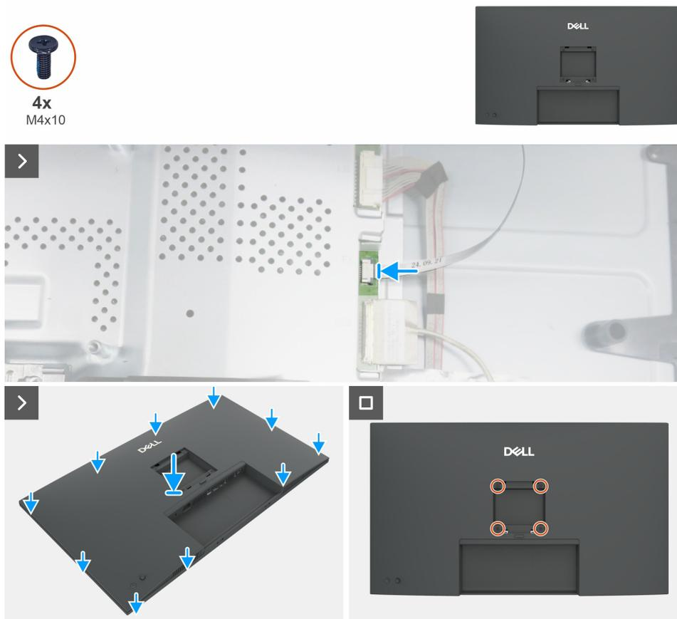
**Figura 16. Instalar la tapa trasera**
