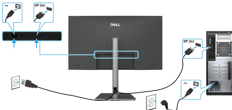
Figura 9. Conexión del cable DisplayPort
