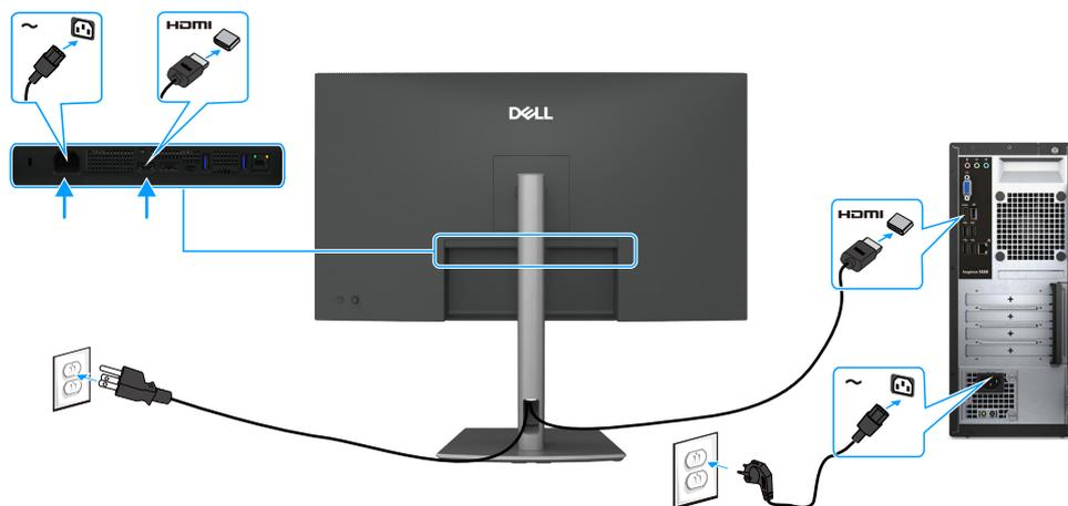
Figura 8. Conexión del cable HDMI
